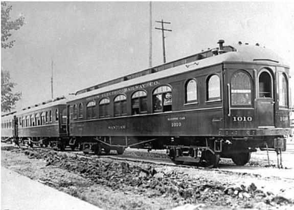
**Figura 1.23 :** carrozza cuccette, Oregon Electric, 1913 , copertura in acciaio al rame
