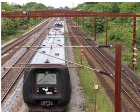
**Figura1.32:** pali da elettrificazione in acciaio corten durante l'utilizzo. Notare come si tratti di un'area aperta, non di una stazione.
