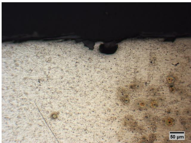
**Figura3.3:** sezione del provino A, lato A, il più aggredito. Notare come l'aggressione sia stata così profonda da consumare lo strato superficiale di prodotti di corrosione.
