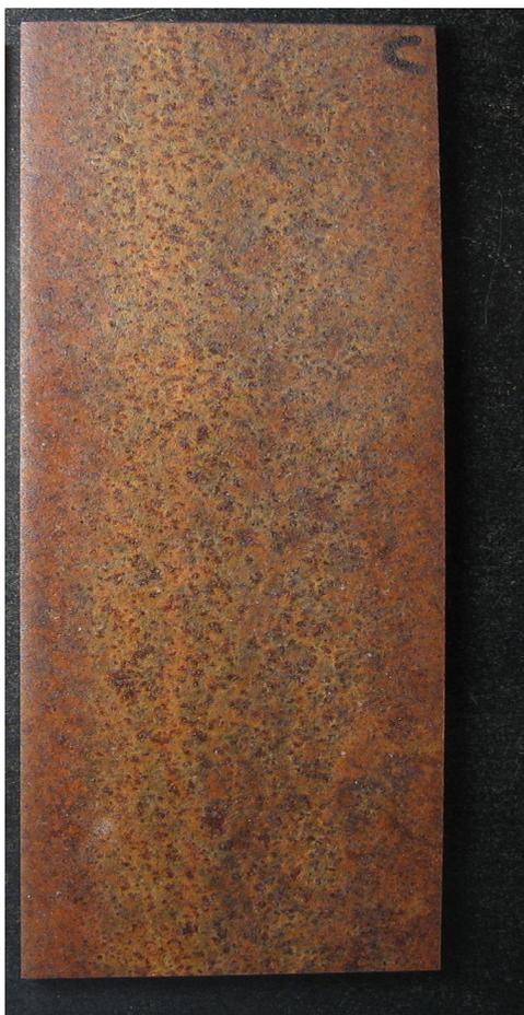
**Figura 2.9:** colorazione del provino C, due cicli d'attacco chimico.
