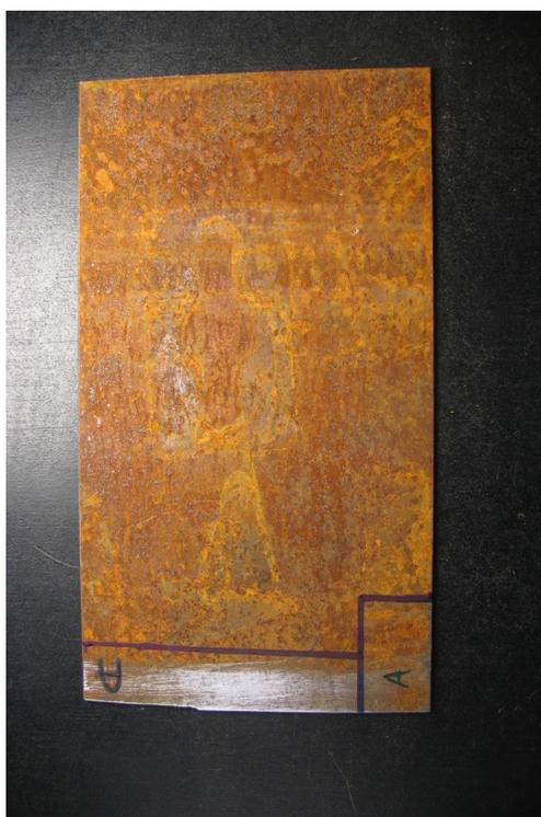
**Figura2.5:** colorazione ottenuta sul campione A, lato A, dopo un trattamento di 4 cicli d'attacco chimico.
