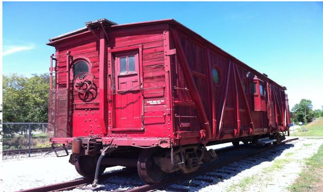
**Figura 1.24:** Carro merci del 1913 modificato in “caboose” (o carro del personale) durante la guerra. Tetto in acciaio al rame.
