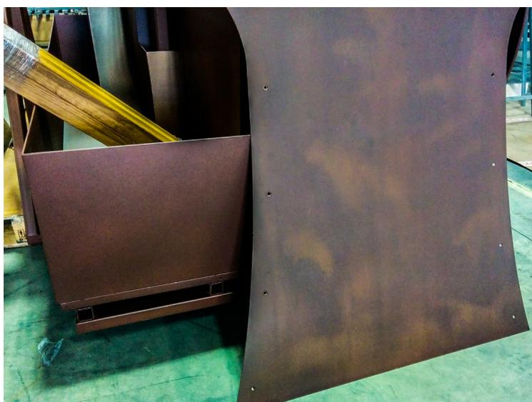
**Figura2.1:** retro della fontana durante la costruzione: dai ritagli della sua costruzione sono stati ricavati i campioni per le analisi
