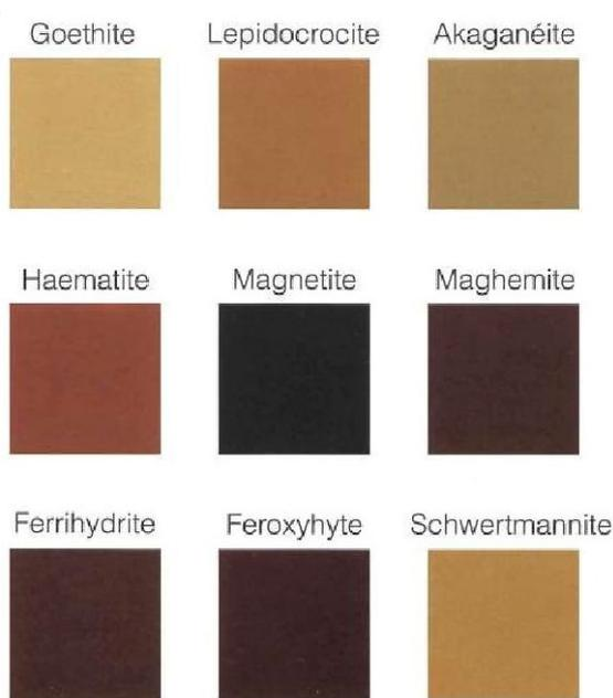
**Figura 1.48:** colorazioni degli ossidi, degli idrossidi e degli ossidrossidi del Ferro[45]
