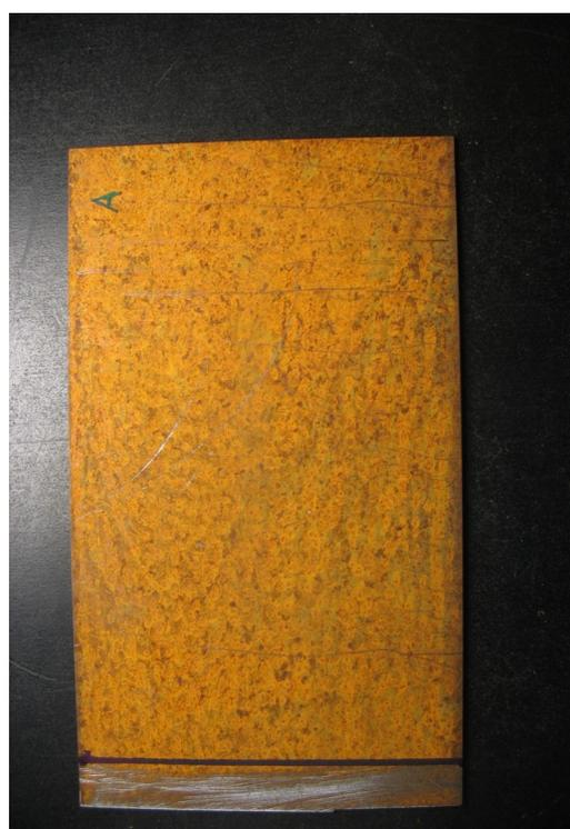
**Figura2.6:** colorazione ottenuta sul campione A, lato B, dopo un trattamento di 5 cicli d'attacco chimico.
