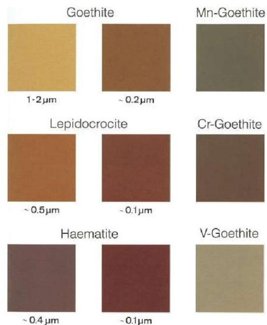
**Figura 1.49:** colorazioni degli ossidi, degli idrossidi e degli ossidrossidi del Ferro[45]
