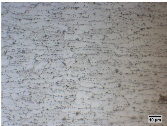
**Figura3.4:** grani allungati nella sezione del provino B, effetto del processo di laminazione.
