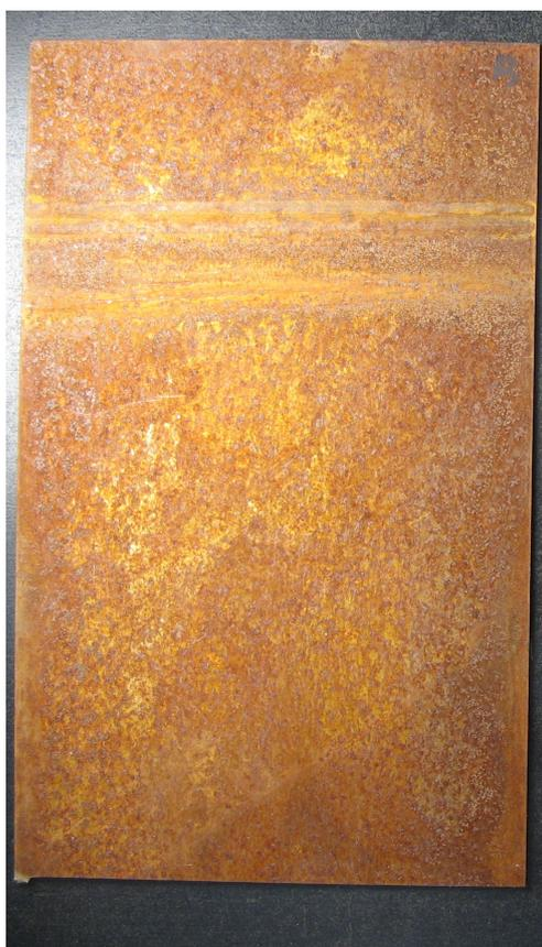
**Figura2.7:** colorazione del provino B, un solo ciclo d'attacco chimico. Notare il colore identico al provino D, a parte l'alone chiaro in centro
