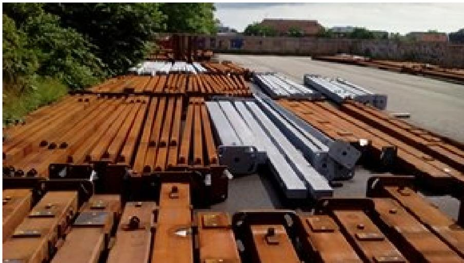
**Figura1.31:** KØGE, Danimarca, nell'immagine un deposito di pali da elettrificazione ad uso ferroviario, notare come siano presenti sia elementi in corten che in acciaio zincato. Cortese concessione dell'azienda GCF srl, con sede legale a Roma, Italia.
