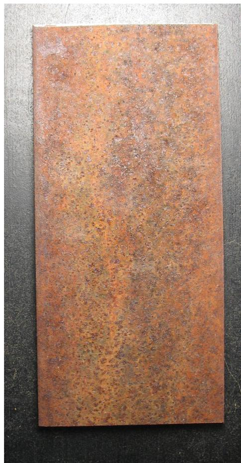
**Figura 2.10:** colorazione del provino E, tre cicli d'attacco
