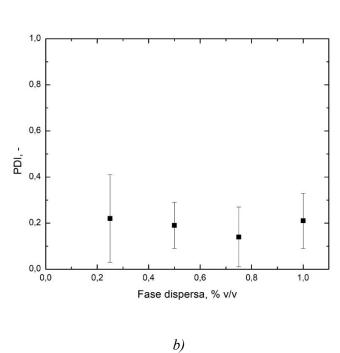
Figura 3.10 Andamento della dimensione a) e PDI b) delle particelle al variare della % di fase dispersa con Ultra Turrax a 14000 rpm per 10 minuti e irraggiamento di 15 minuti, usando i rapporti della formulazione E.
