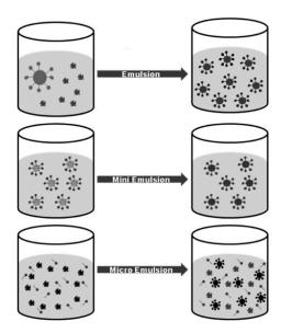
**Figura 1.3** Schema di un'emulsione, miniemulsione e microemulsione, prima e dopo polimerizzazione (Immagine modificata da [9]).
