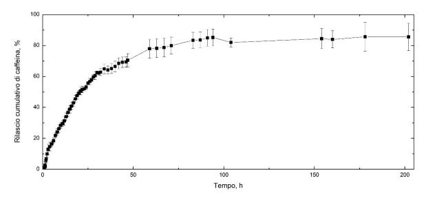
Figura 3.21 Curva del rilascio controllato di caffeina da nanoparticelle ottenute utilizzando i rapporti della formulazione E con Ultra Turrax a 14000 rpm per 10 min e 15 min di irraggiamento.
