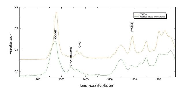
Figura 3.16 Spettri FT-IR di PEGDA e residuo secco carico di caffeina con i rapporti della formulazione E con Ultra Turrax a 14000 rpm per 10 min e tempo di irraggiamento di 15 min.
