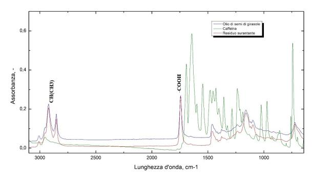
Figura 3.18 Spettri FT-IR di caffeina, olio di semi di girasole e surnatante con i rapporti della formulazione E con Ultra Turrax a 14000 rpm per 10 min e tempo di irraggiamento di 15 min.
