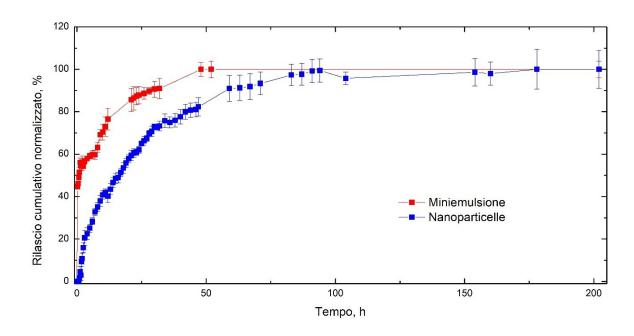
Figura 3.29 Confronto delle curve del rilascio cumulativo normalizzate per nanoparticelle ottenute utilizzando i rapporti della formulazione E con Ultra Turrax a 14000 rpm per 10 min e 15 min di irraggiamento e per la miniemulsione prodotta nelle stesse condizioni operative.
