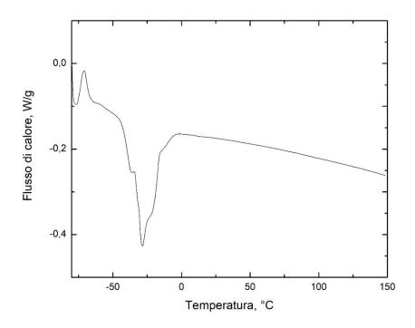
**Figura 3.8** DSC del residuo solido del campione 6, eseguito con Ultra Turrax e tempo di irraggiamento di 15 min, con i rapporti della formulazione E.
