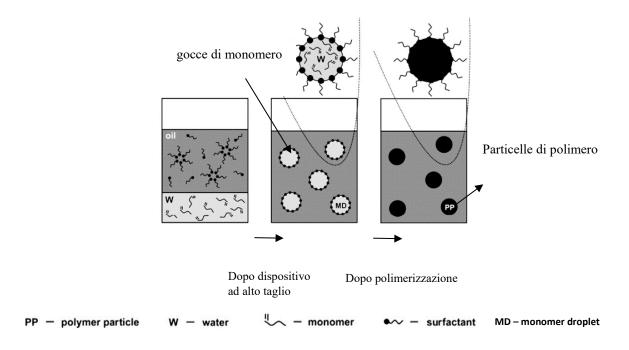
Figura 1.5 Polimerizzazione in miniemulsione inversa (Immagine modificata da [18]).
