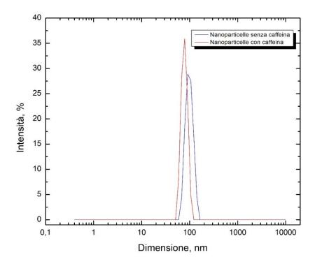
**Figura 3.13** Distribuzione dimensionale degli idrogel con e senza caffeina, con i rapporti della formulazione E con Ultra Turrax a 14000 rpm per 10 min e tempo di irraggiamento di 15 min.
