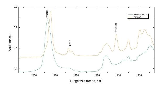
**Figura 3.9** Spettro FT-IR del PEGDA e del residuo secco del campione 6, prodotto con Ultra Turrax e tempo di irraggiamento di 15 min, con i rapporti della formulazione E.
