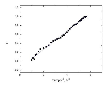
Figura 3.24 Regressione lineare del rilascio con il modello di Higuchi.
