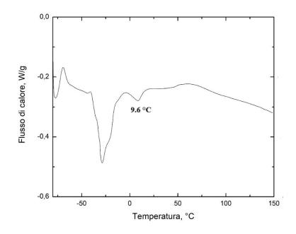
Figura 3.7 DSC del residuo del campione 5, prodotto con Ultra Turrax e tempo di irraggiamento di 10 min, con i rapporti della formulazione E.
