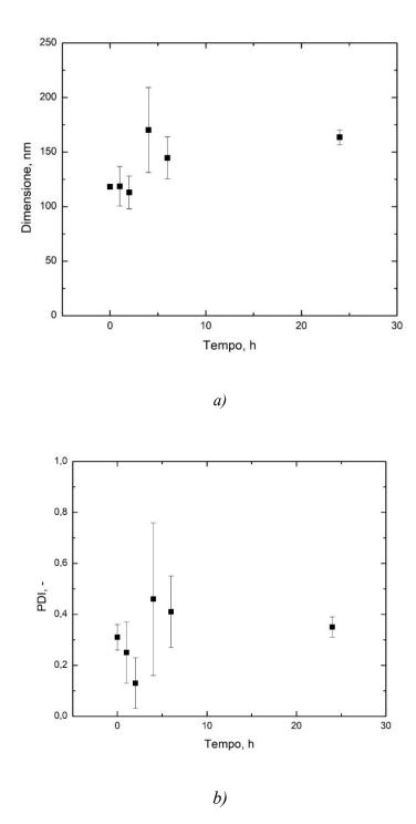
Figura 3.12 Andamento nel tempo della dimensione a) e PDI b) delle nanoparticelle con Ultra Turrax a 14000 rpm per 10 min con irraggiamento di 15 minuti, con i rapporti della formulazione E.
