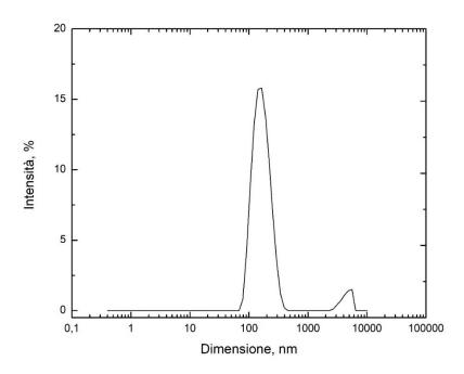
Figura 3.2 Distribuzione dimensionale di nanoparticelle prodotte con Ultra Turrax e 25 min di irraggiamento. I risultati si riferiscono ai rapporti della formulazione E.
