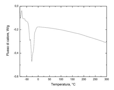
Figura 3.15 DSC del residuo secco di idrogel con caffeina, con i rapporti della formulazione E con Ultra Turrax a 14000 rpm per 10 min e tempo di irraggiamento di 15 min.
