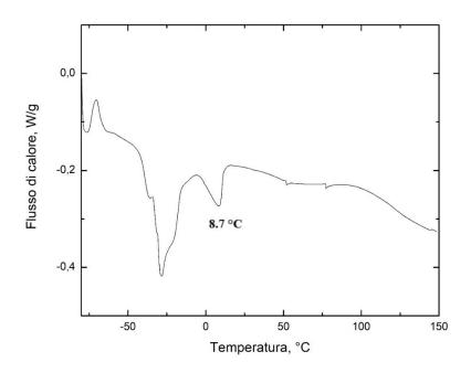
**Figura 3.6** DSC del residuo della miniemulsione non polimerizzata, eseguita con Ultra Turrax e con i rapporti della formulazione E.
