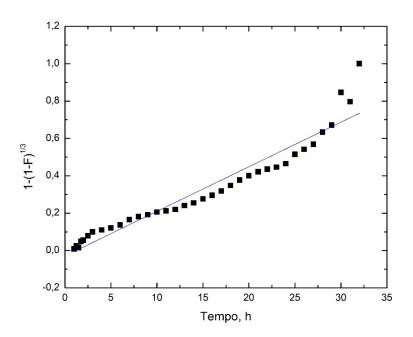
Figura 3.25 Regressione lineare del rilascio con il modello di Hixon-Crowell.
