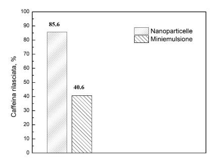
Figura 3.30 Quantità di caffeina rilasciata caffeina da nanoparticelle prodotte utilizzando i rapporti della formulazione E con Ultra Turrax a 14000 rpm per 10 min e 15 min di irraggiamento e da miniemiemulsione prodotta nelle stesse condizioni operative.
