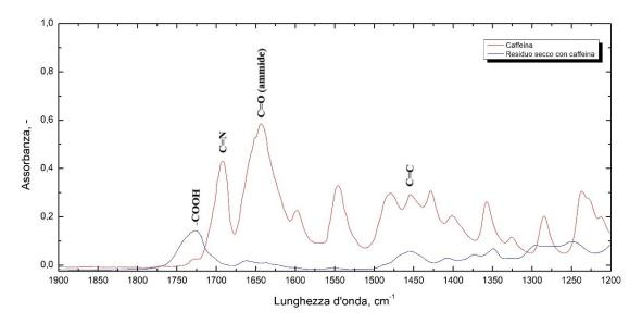
Figura 3.17 Spettri FT-IR di caffeina e residuo secco carico di caffeina con i rapporti della formulazione E con Ultra Turrax a 14000 rpm per 10 min e tempo di irraggiamento di 15 min.
