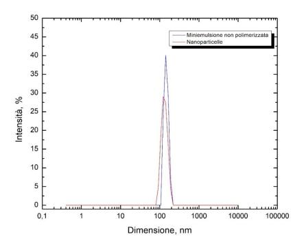
**Figura 3.3** Distribuzione dimensionale della miniemulsione non polimerizzata e dopo 15 min di irraggiamento. I risultati si riferiscono ai rapporti della formulazione E con Ultra Turrax.
