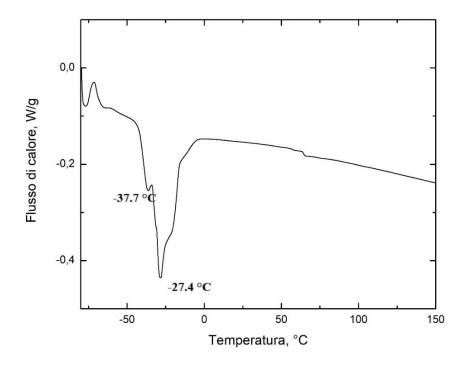
Figura 3.4 DSC dell'olio di semi di girasole.
