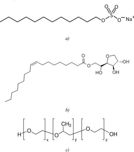
Figura 2.4 Rappresentazione di SDS a), Span 80 b) e Pluronic c).
