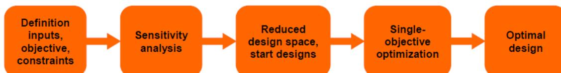
Figura 4.1: Flow-chart della procedura di ottimizzazione deterministica con singola funzione obiettivo [38].
