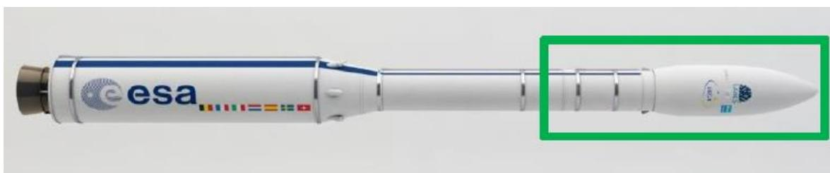
Figura 2.4: Porzione del lanciatore *Vega* sostituita con endoreattore ibrido [20].
