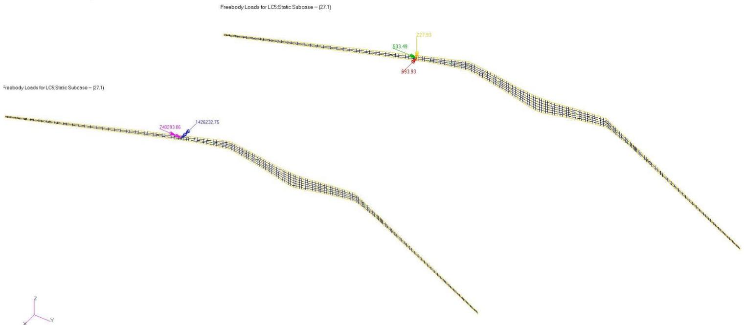
**Figura 6.13:** *Freebody Loads* nella sezione più sollecitata del longherone posteriore nel *Caso 305020*
