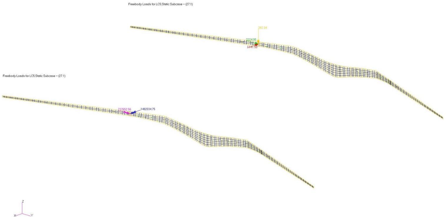
**Figura 6.12:** *Freebody Loads* nella sezione più sollecitata del longherone posteriore nel *Caso 304030*
