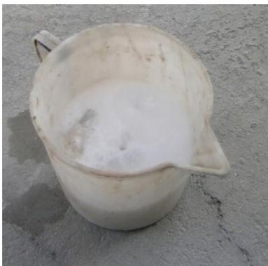
Fig. 7 - Inizia la reazione dell'acqua con l'ossido di calcio dalla quale si ottiene l'idrossido di calcio.
