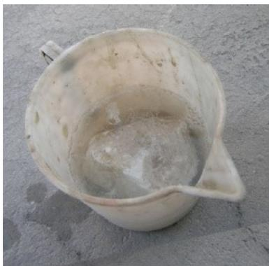
Fig. 6 - Una zolla di calce viva viene immersa in una caraffa piena di acqua
