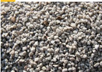
Perlite grezza a granulometria media (0,3 -1,2 mm) e grossolana (0,8 -2,5 mm), naturale, atossica, inerte, non combustibile: si tratta di una varietà specifica di roccia vulcanica effusiva della famiglia delle rioliti.
