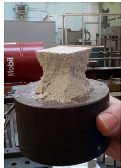
Fig. 39 - Rottura provino a compressione
