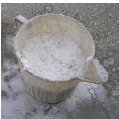
Fig. 9 - Al termine della reazione la zolla si è disfatta, si è creata una pasta di idrossido di calcio.
