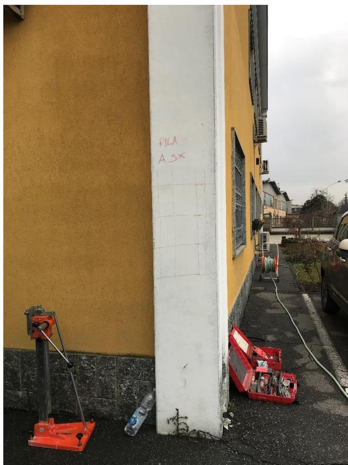
Figura 51 Traccia delle armature individuate a seguito dell'utilizzo del pacometro
