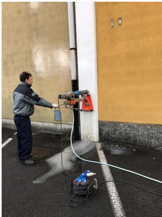
*Figura 53 Estrazione provino di cls mediante carotatrice*
