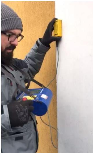
Figura 50 Utilizzo pacometro per individuazione delle barre di armatura
