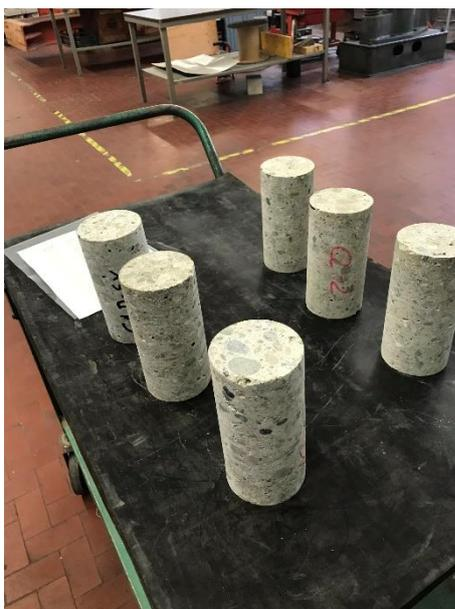
Figura 64 Provini di cls sottoposti a molatura.
