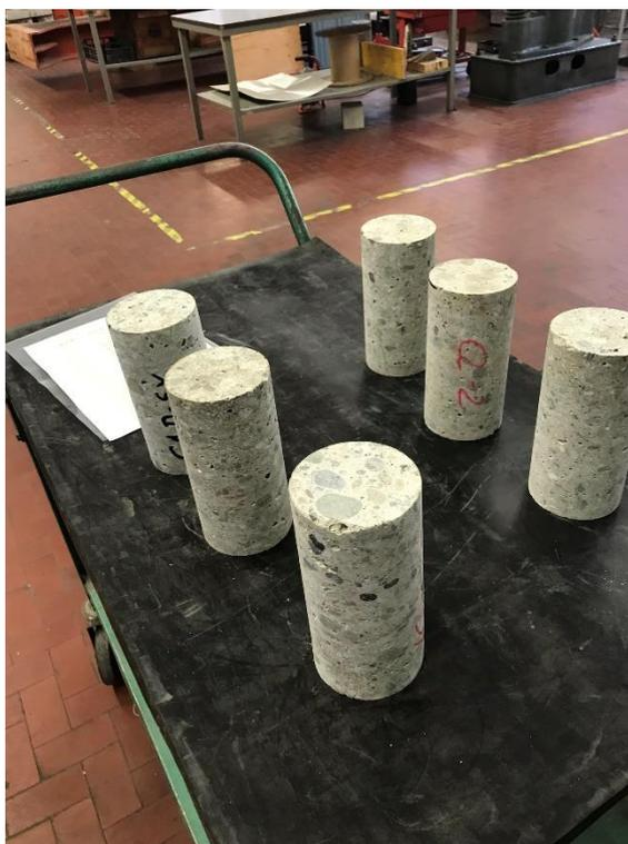
*Figura 55 Sei provini cilindrici estratti di calcestruzzo*
