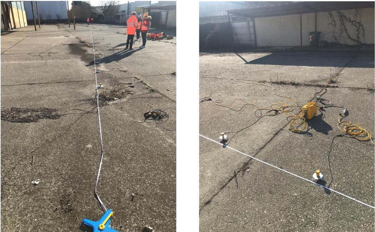
Figura 28 Foto scattate in sito, a sinistra posizionamento completo dei geofoni sulla lunghezza del territorio, a destra un dettaglio di uno dei due geofoni utilizzati.
