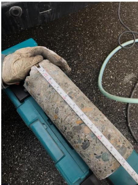
*Figura 54 Provino cilindrico estratto*
