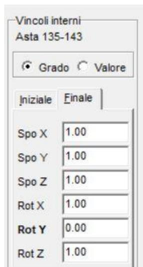
Figura 114 Dettaglio del vincolo cerniera inserito
