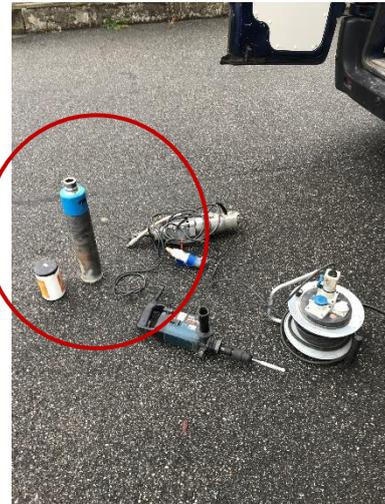
*Figura 52 Strumenti utilizzati, a sinistra vi è la carotatrice, e a sinistra la fustella con denti diamantati*
