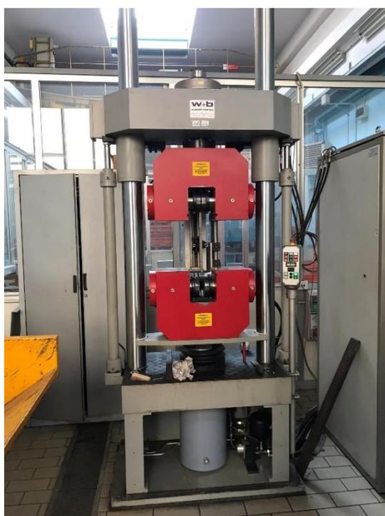
Figura 67 Macchina per prova a trazione barre d'acciaio.
