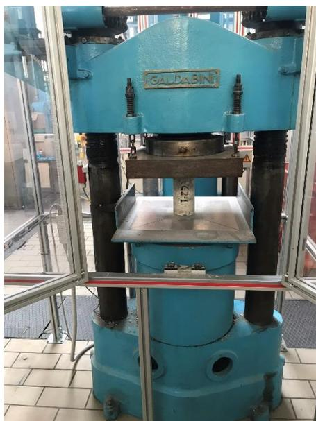
Figura 63 Pressa per prova di compressione su carote di cls.
