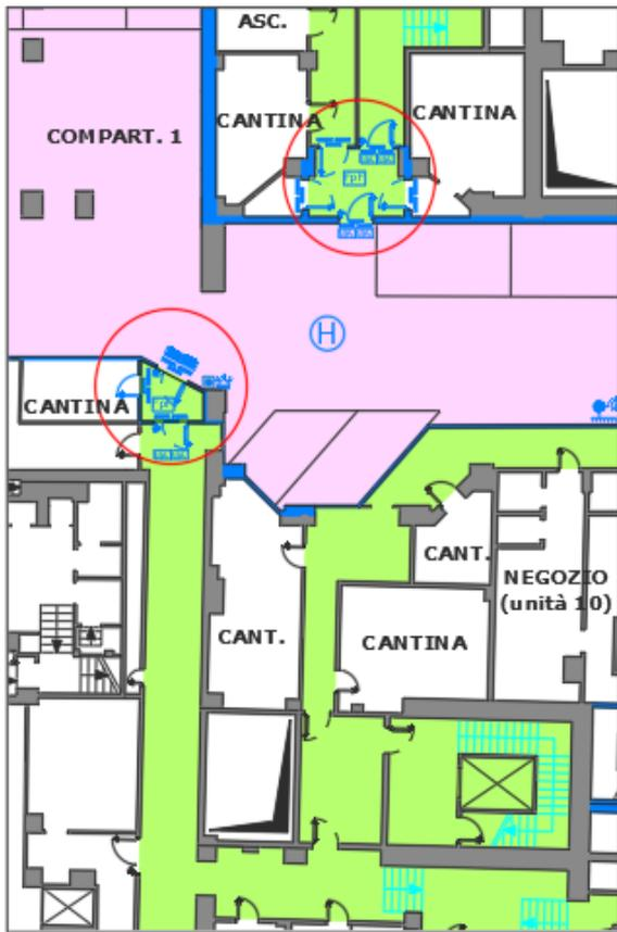
Fig.49 - Filtri a prova di fumo compart. 1
