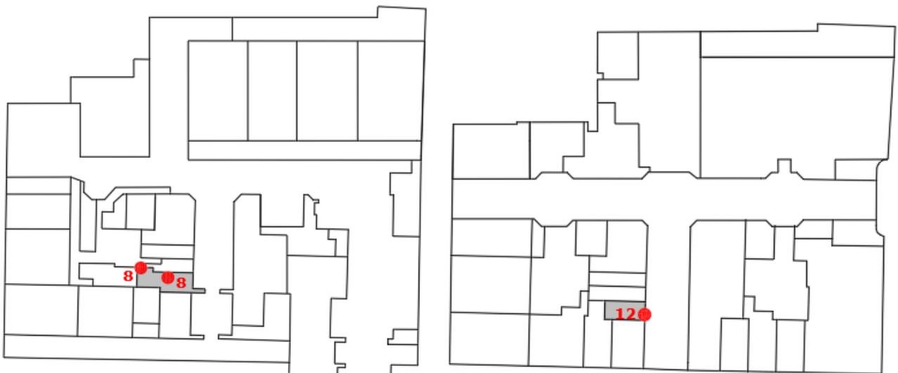
Fig.24a e 24b – Affollamento per ogni uscita, piano -1 e piano terra (negoziò, unità 14)
