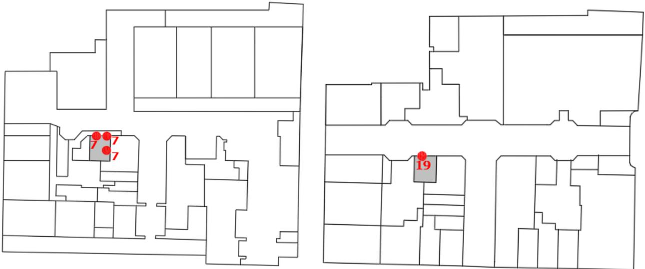
Fig.21a e 21b – Affollamento per ogni uscita, piano -1 e piano terra (negozio, unità 10)
