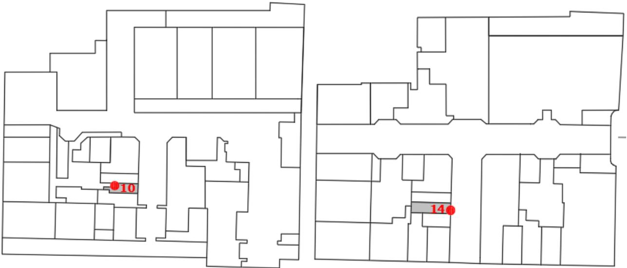
Fig.23a e 23b – Affollamento per ogni uscita, piano -1 e piano terra (negoziò, unità 13)
