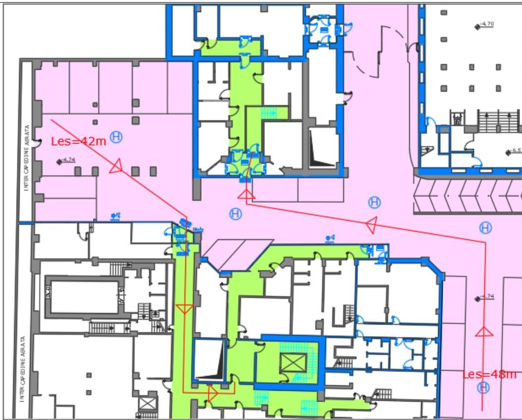
Fig.63 – Percorsi di esodo compartimento 1
