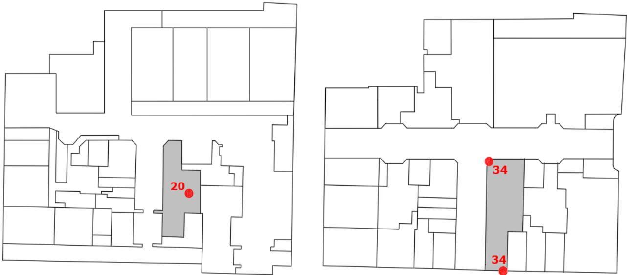
*Fig.13a e 13b – Affollamento per ogni uscita, piano -1 e piano terra (negoziò, unità 01)*
