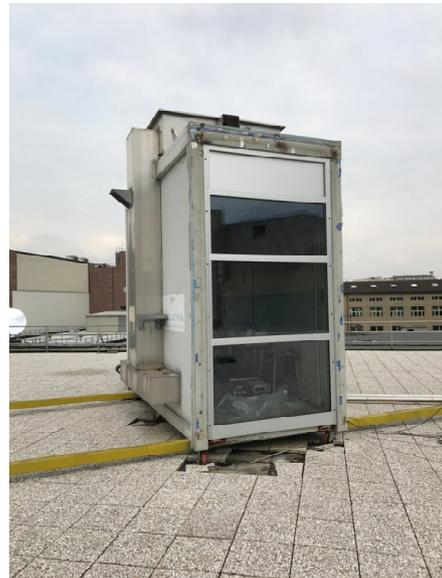
La definizione dei flussi che attraversano la parete e la misura delle temperature superficiali interne ed esterne saranno rilevate mediante un sistema termocoppie e termo flussimetri collegati ad un DataTaker che traduce il segnale elettrico in informazioni in termini di flusso che lo attraversa e di temperature.
