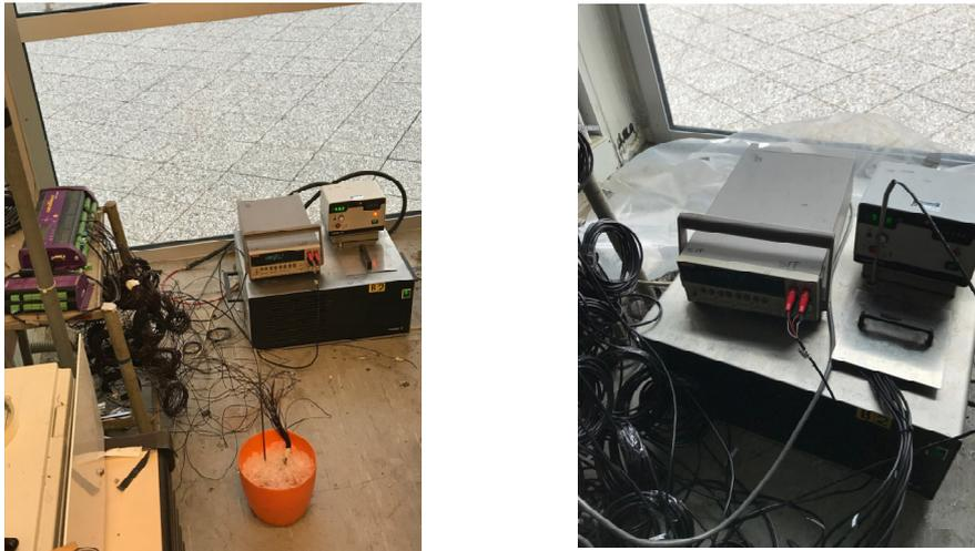
*Figura 117 Termocoppie immerse nel ghiaccio e nel bagno termostatico*
