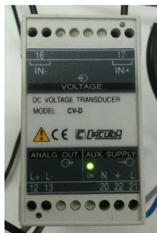
Figura 7.14. Trasduttore di tensione CV-D
