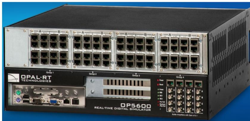
Figura 2.14. Simulatore Real-Time OP5600
