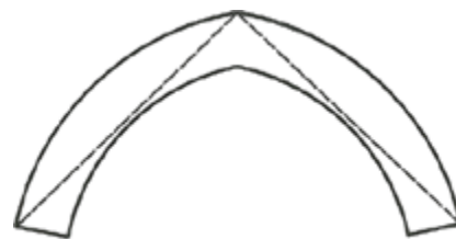
Fig. 38: Leonardo daVinci: metodo di proporzionamento gemoetrico. fonte: Antonio Giuffrè, La meccanica nell'architettura, la statica, pag 202
