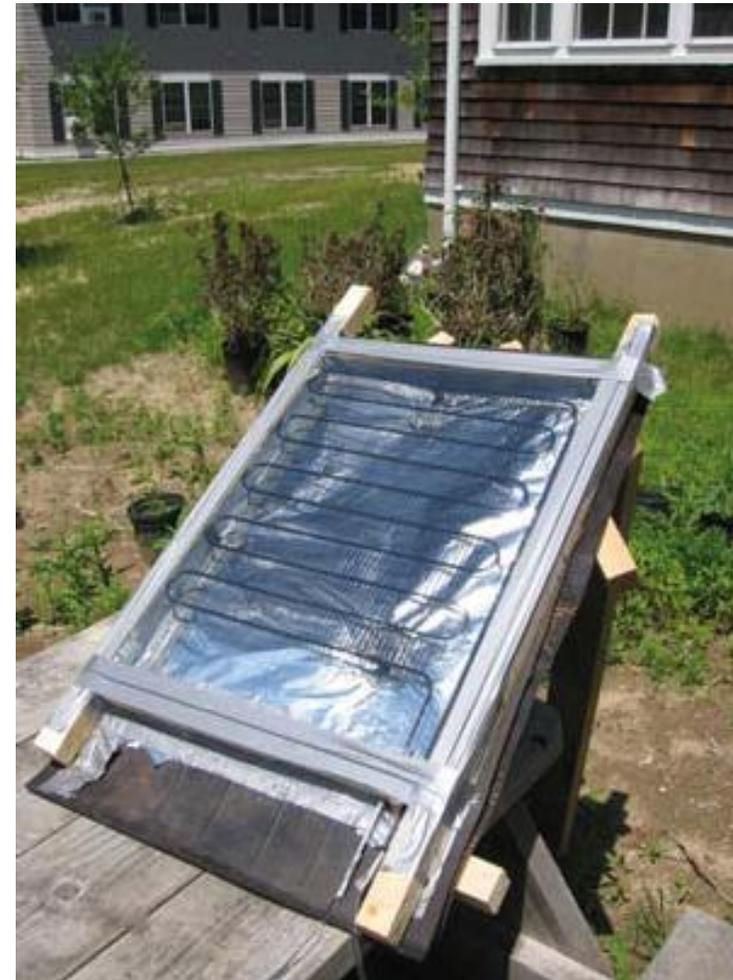
Scaldacqua solare autocostruito utilizzando un pannello a serpentina di un vecchio frigorifero
