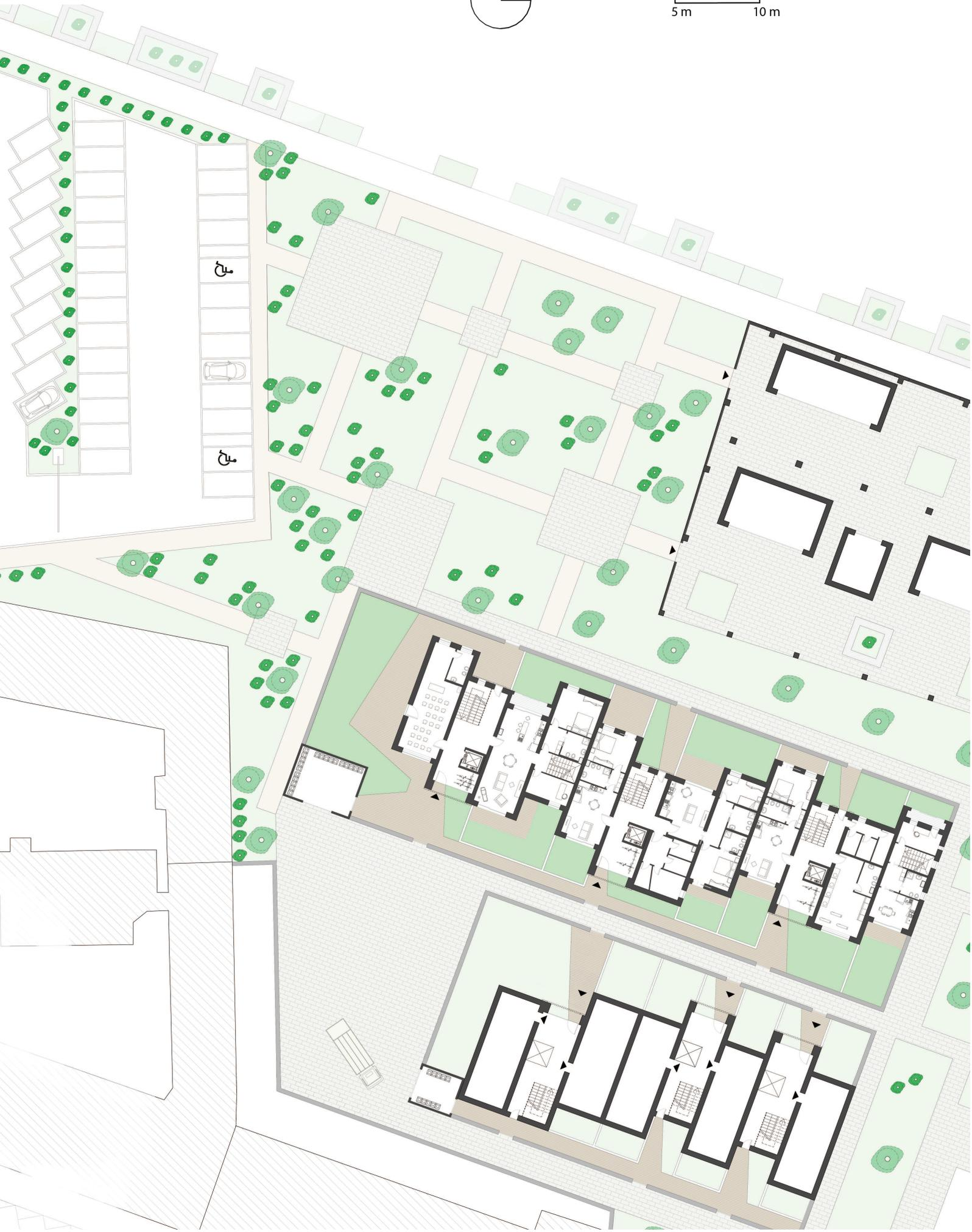
La semplicità delle operazioni di cantiere di tale materiale ha permesso inoltre di stabilire una modularità alla base della progettazione: si è pensato così di sfruttare la manica di 12 metri e di dotarla di una luce di 5 metri, dimensioni tali da garantire la predisposizione di almeno un bilocale, all'interno di ogni singolo "blocchetto".
