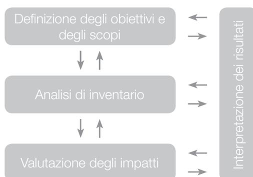
Figura 5.3 - Fasi di un'analisi LCA secondo la ISO 14040
