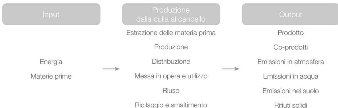
Figura 5.2 - Fasi di un’analisi del ciclo di vita LCA
