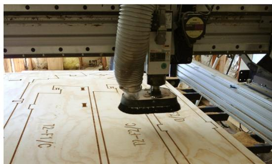
Figura 2.21 - CNC, taglio del compensato
