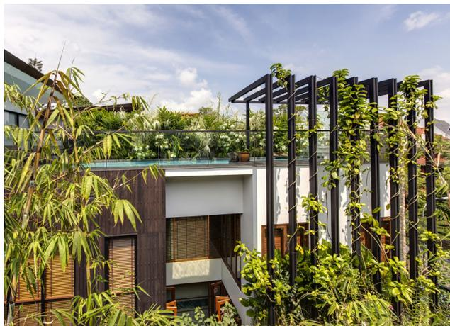
Fig.15\_Pergola invertita utilizzata come elemento di schermatura
