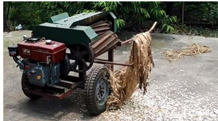
Fig 3.3 Decortificatore dei fusti di canapa portatile (SHIV)
