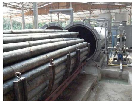
Fig 5.4 Impianto di trattamento del bambù in autoclave (thailandbamboo.com)
