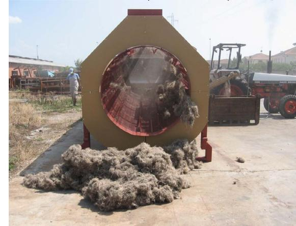
Fig 2.17 Modulo pulizia impianto Assocanapa (Overgrow-italy.nl)
