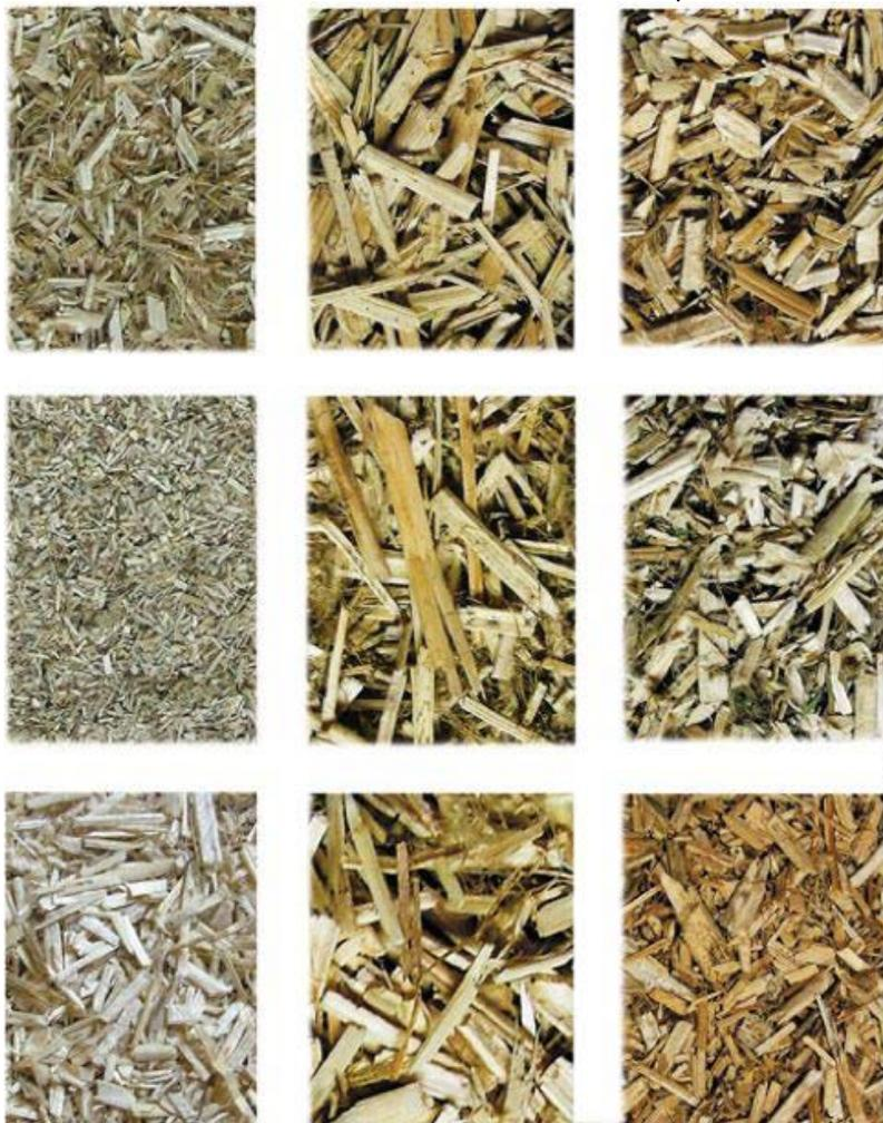
Fig 2.7 Differenti pezzature di canapulo (Building with hemp-Allin)
