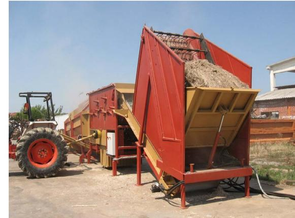
Fig 2.15 Modulo alimentazione impianto Assocanapa (Overgrow-italy.nl)
