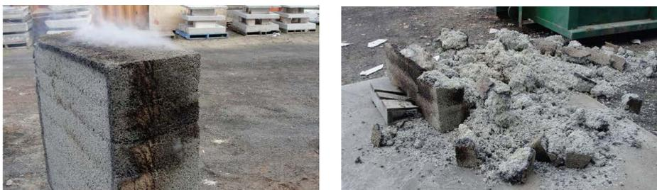
Fig 2.89-90 Test di resistenza al fuoco dopo 36 e 72 ore
