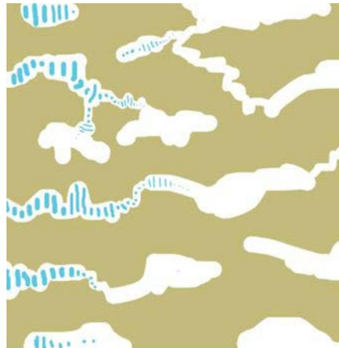
Fig 2.96 Le onde sonore penetrano il getto in canapulo e calce venendo dissipate dalla conformazione dei vuoti della struttura del materiale (Building with Hemp-Allin)
