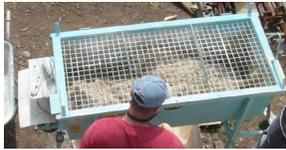
Fig 2.40 Miscelatore a vite senza fine (HempEcoSystem)
