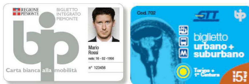
Figura 2. 10 I titoli di viaggio introdotti dal progetto BIP: Supporto ISO 1444B (a sinistra) e MIFARE Ultralight (a destra). Fonte: http://gtt.to.it
