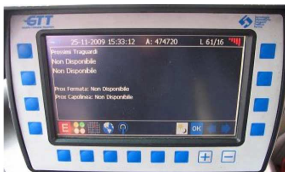
Figura 2. 7 Sistema SIS di bordo a supporto degli autisti. Fonte: http://www.tramditorino.it
