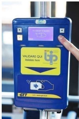
Figura 2. 9 Apparato BIP per la validazione elettronica dei titoli di viaggio. Fonte: http://www.gtt.to.it
