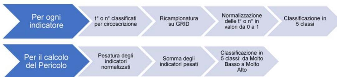
Figura 4-6: Rappresentazione schematica del procedimento per realizzare la classificazione del pericolo attraverso l'elaborazione degli indicatori [produzione propria].
