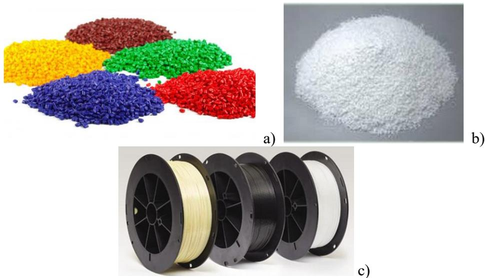
**Figura 2.31** Pellets per stampaggio a iniezione (a), polveri per SLS (b), filo per FDM (c)
