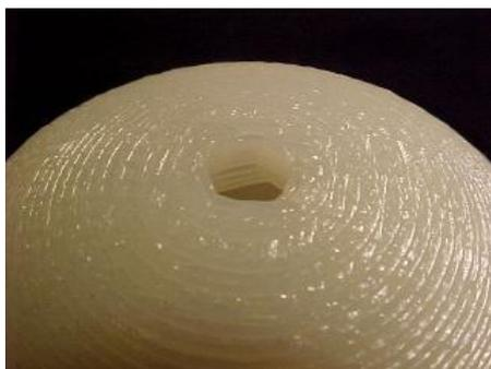
**Figura 2.32** Sfera stampata con tecnologia FDM.
