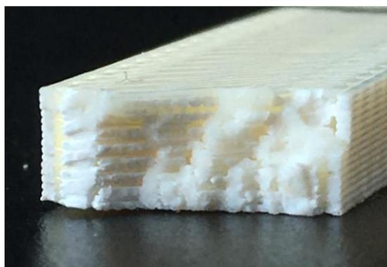
**Figura 4.63** Superficie di frattura del campione XY.
