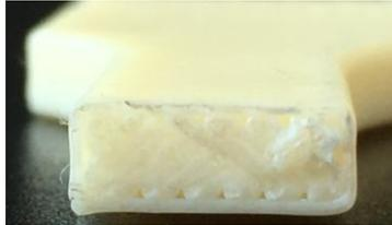
**Figura 4.71** Superficie di frattura del campione ZX.
