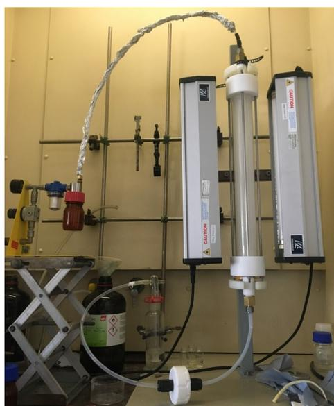
Figura 2: Strumentazione completa: atomizzatore, foto-reattore, filtro.
