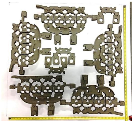
Figura 96 Posizionamento delle anime all'interno dei box di PP
