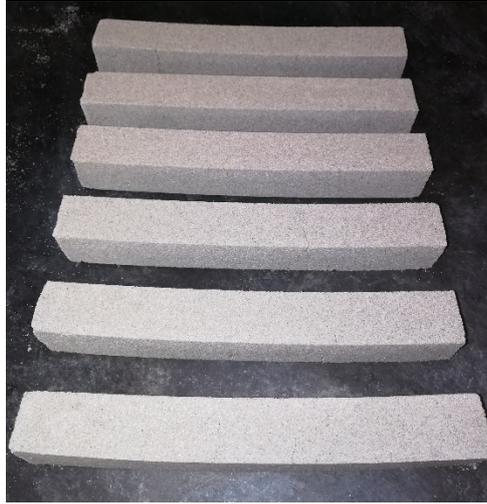
Figura 40 Aspetto dei provini dopo il mantenimento a condizioni estreme di umidità relativa (70%, 80%, 85% UR)
