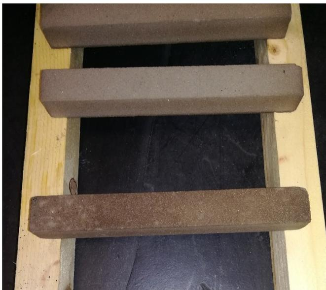
*Figura 91 Campioni dopo trattamento in forno a muffola a 450°C*
