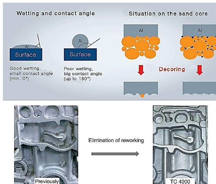
Figura 22 Meccanismo di azione dell'additivo per ottimizzare la qualità superficiale del getto (Muller, Deters, & Oberleiter, 2015)
