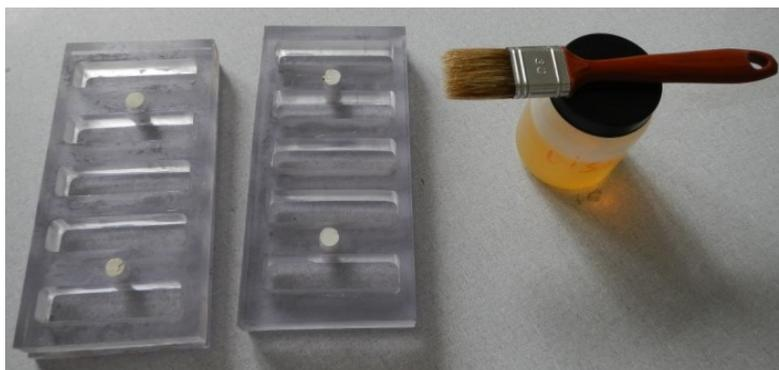
**Figura 3.10:** Stampi durante l'operazione di spalmatura del distaccante a base siliconica.
