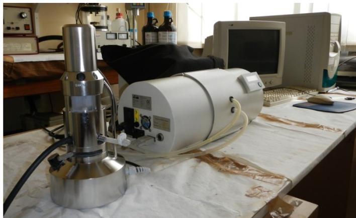
**Figura 4.3:** Granulometro “Laser Particle Sizer Analysette 22 Compact”, impiegato nelle analisi granulometriche effettuate durante questo lavoro di tesi.
