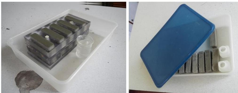
**Figura 3.14:** A sinistra: introduzione degli stampi nel contenitore per la stagionatura in ambiente umido, il sistema verrà successivamente chiuso da un coperchio. A destra: proseguo post-estrazione della stagionatura in ambiente umido.
