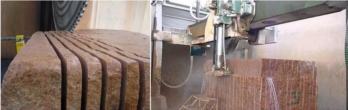
**Figura 2.1:** Macchinari ad una lama (a sinistra) o più lame circolari (a destra) per il taglio delle pietre. (Fonte:www.google.it)
