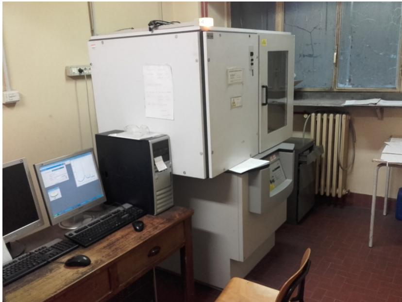
**Figura 4.4:** Diffratometro di raggi X, impiegato per le caratterizzazioni composizionali effettuate durante questo lavoro di tesi.
