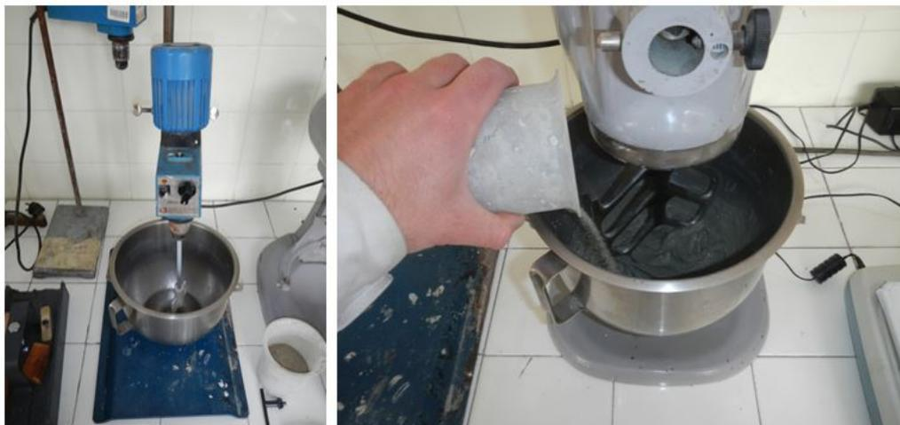
**Figura 3.11:** A sinistra: prima fase della miscelazione con miscelatore a colonna. A destra: fase di aggiunta della sabbia in impastatrice.
