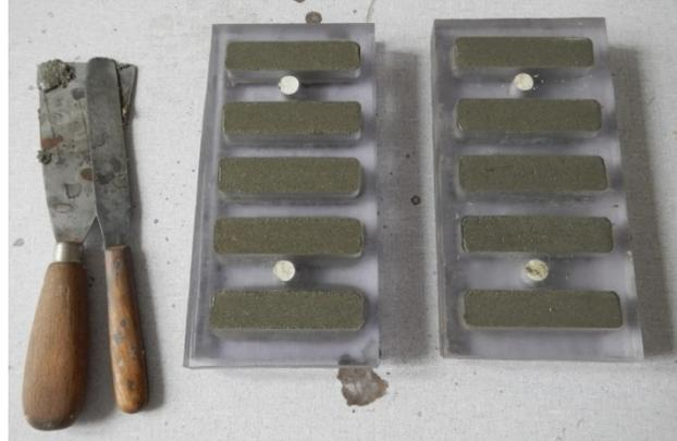
**Figura 3.12:** Palette metalliche impiegate e stampi, a completata operazione di messa in stampo dell'impasto appena mescolato.
