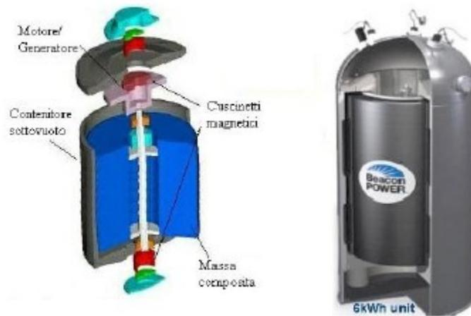
Figura 31. Struttura volano [10]
