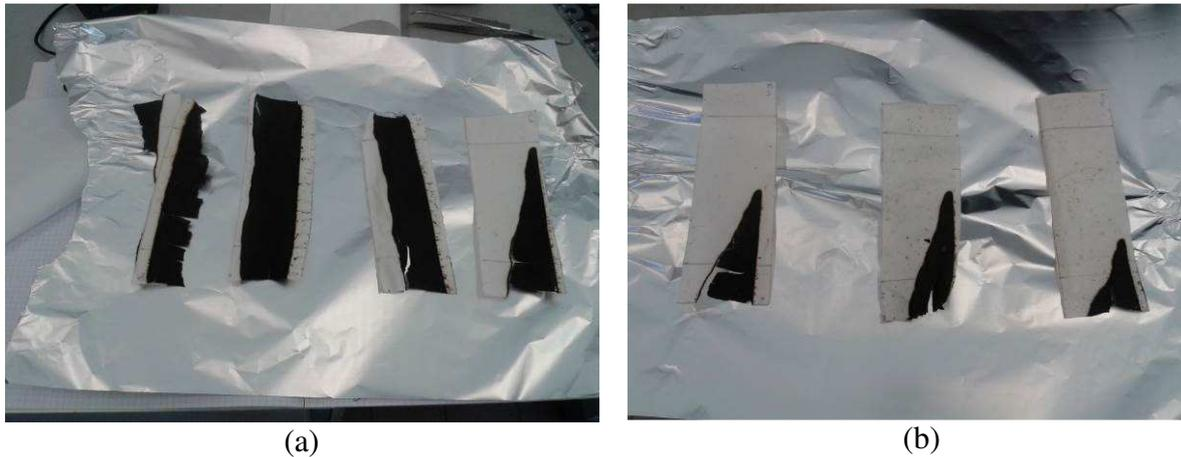
**Figura 4.22:** foto campioni ottenuti con la prova UL94 in configurazione orizzontale: (a) 5 Strati, (b) 10 strati.
