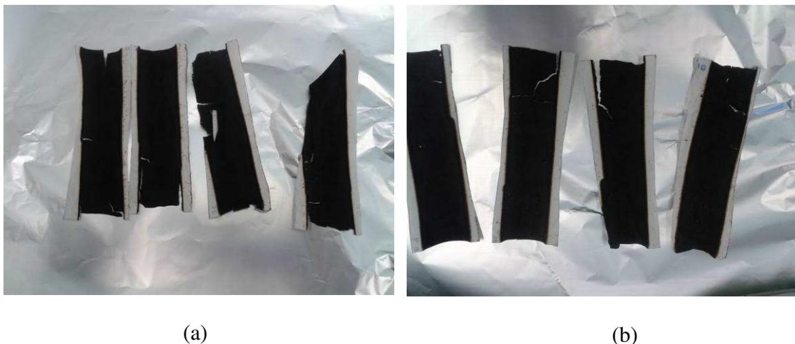
**Figura4.23:** foto campioni ottenuti con prova UL 94 in configurazione verticale (a) 5 strati, (b) 10 strati
