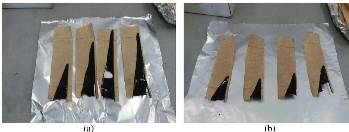
**Figura 4.34:** foto campioni ottenuti con la prova UL94 in configurazione orizzontale: (a) 5 Strati, (b) 10 strati.
