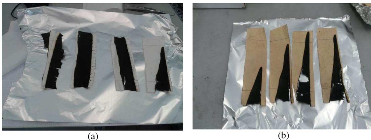
**Figura 4.42:** foto campioni ottenuti con la prova UL94 in configurazione orizzontale: (a) Cotone 5 1% (b) Cotone 5 1% HT.
