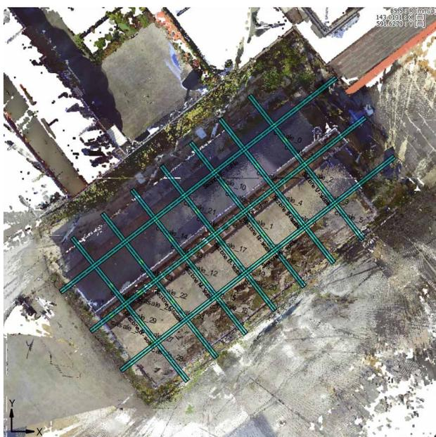
**Figura 21** - Identificazione delle sezioni su software PointCab.
