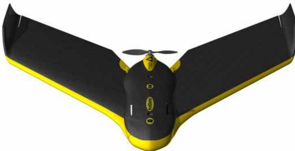
**Figura 8** - Esempio di drone ad ala fissa, modello eBee SenseFly.<sup>1</sup>
