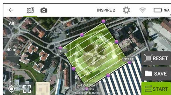
**Figura 12** - Programmazione del volo automatico, piano di volo. Software PiX4D.
