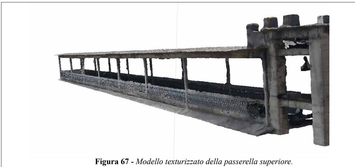
**Figura 67** - Modello texturizzato della passerella superiore.
