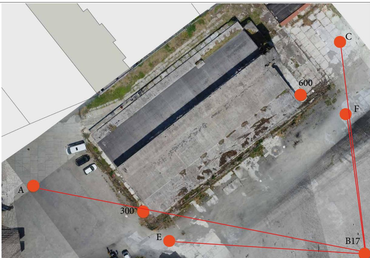
**Figura 7** - Rete topografica nel piazzale esterno, (in rosso) baseline, visualizzata sull'ortofoto.
