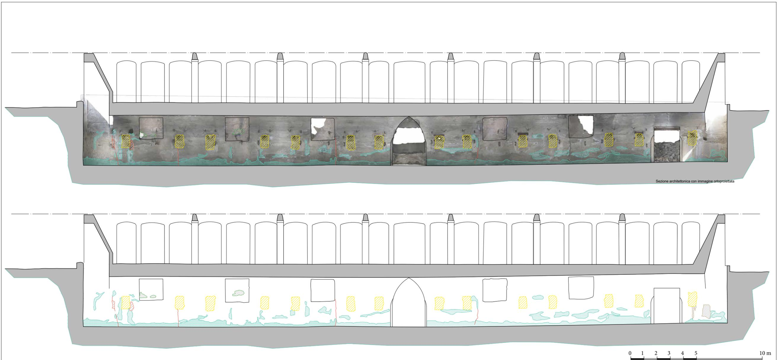
**Figura 13** - *Sopra, sovrapposizione dell'immagine con l'elaborato 2D, con rappresentazione dei degradi, sezione A-A.*
