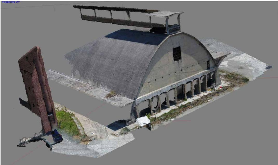
**Figura 52** - Nuvola densa derivante dall'allineamento automatico.
