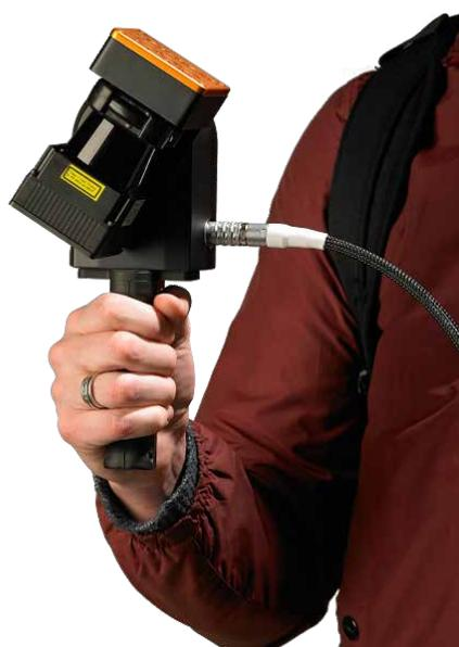
**Figura 23** - Impiego del modello GeoSlam Zeb REVO.<sup>3</sup>
