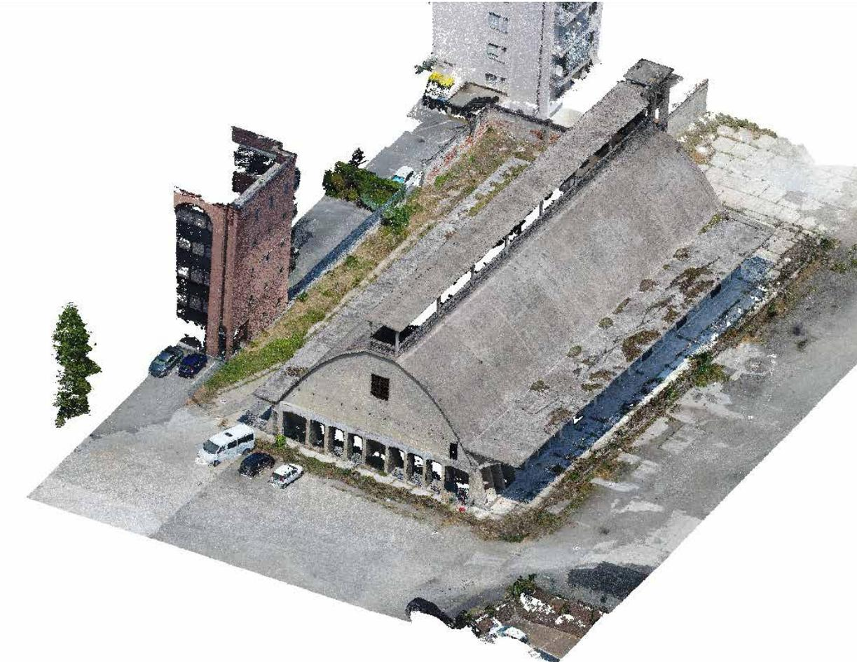
**Figura 64** - *Modello fotogrammetrico texturizzato del paraboloide.*
