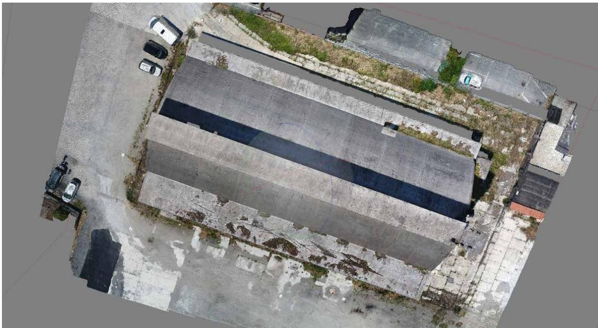
**Figura 53** - Vista superiore della nuvola densa completa.
