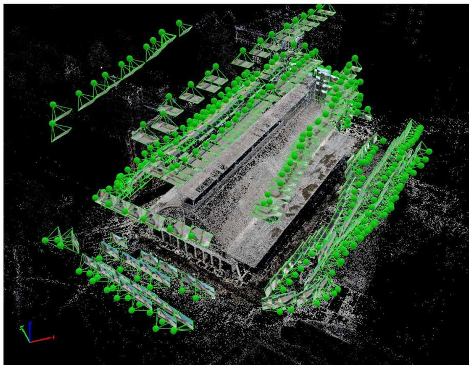
**Figura 56** - Identificazione delle posizioni successive della camera (centri di presa) durante il volo del drone.
