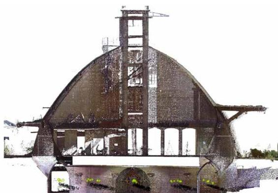
**Figura 22** - Esempio di sezione estratta mediante PointCab, rappresentante la nuvola del 2017 unita a quella del 2012.
