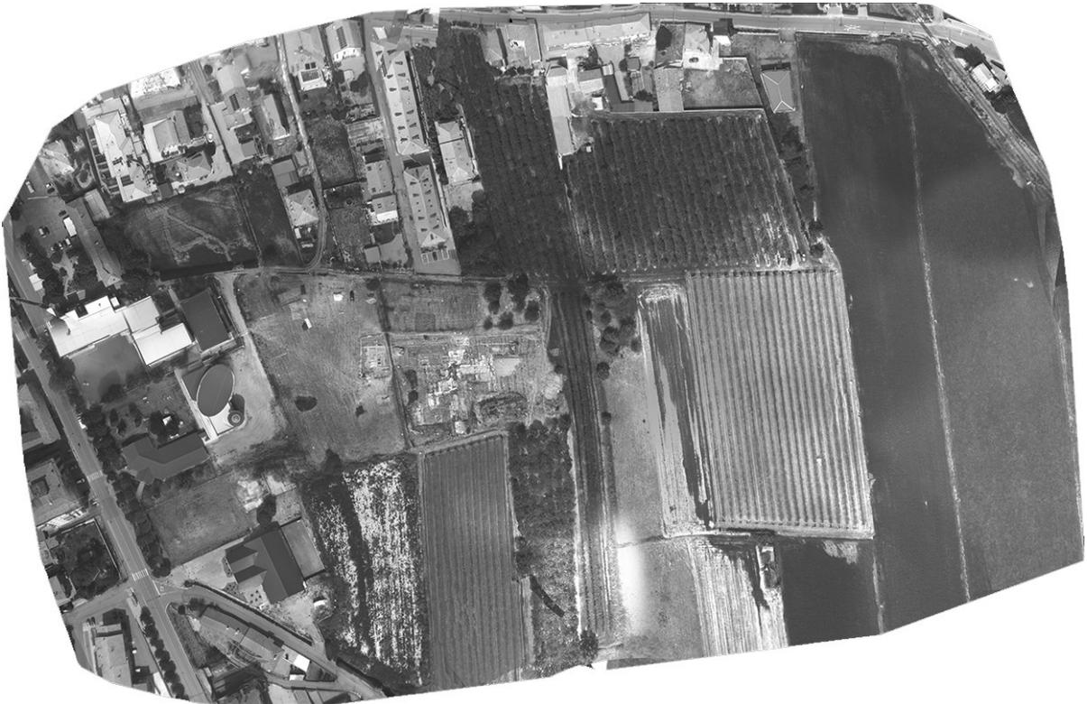
*Figura 41 \_ Costigliole Saluzzo: ortofoto generata dall'elaborazione del blocco fotogrammetrico del sensore multispettrale.
