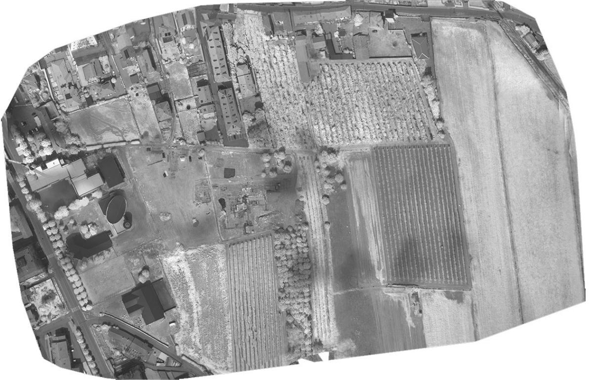
*Figura 42\_ Costigliole Saluzzo: ortofoto generata dall'elaborazione del blocco fotogrammetrico del sensore multispettrale.
