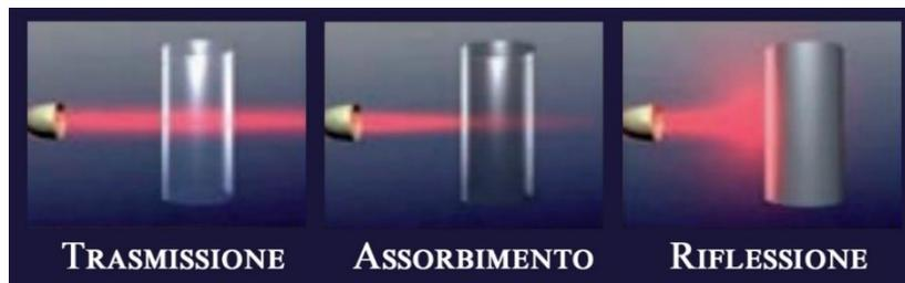
Figura 9\_Modi di interazione della radiazione elettromagnetica con il campione.
