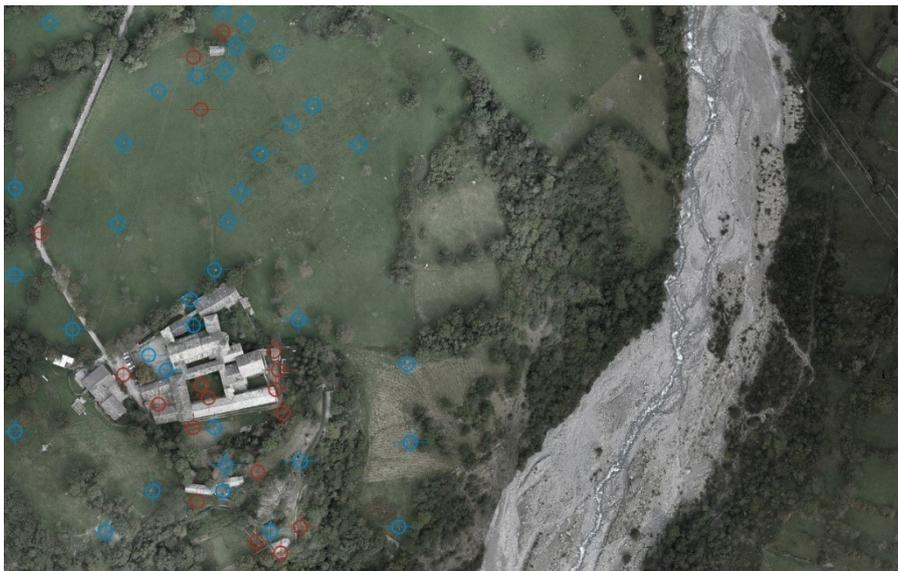
*Figura 24 Novalesa: In rosso i vertici della rete d'inquadramento principale. In blu i marker della rete di dettaglio*
