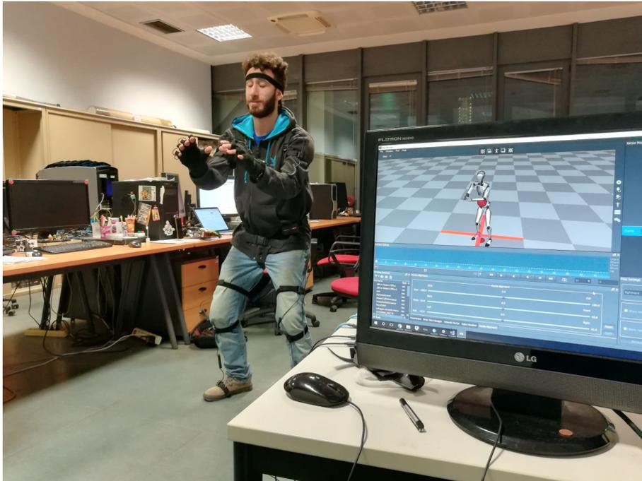
Figura 4.2: Esempio di cattura dei movimenti con il software AXIS Neuron e la tuta Perception Neuron
