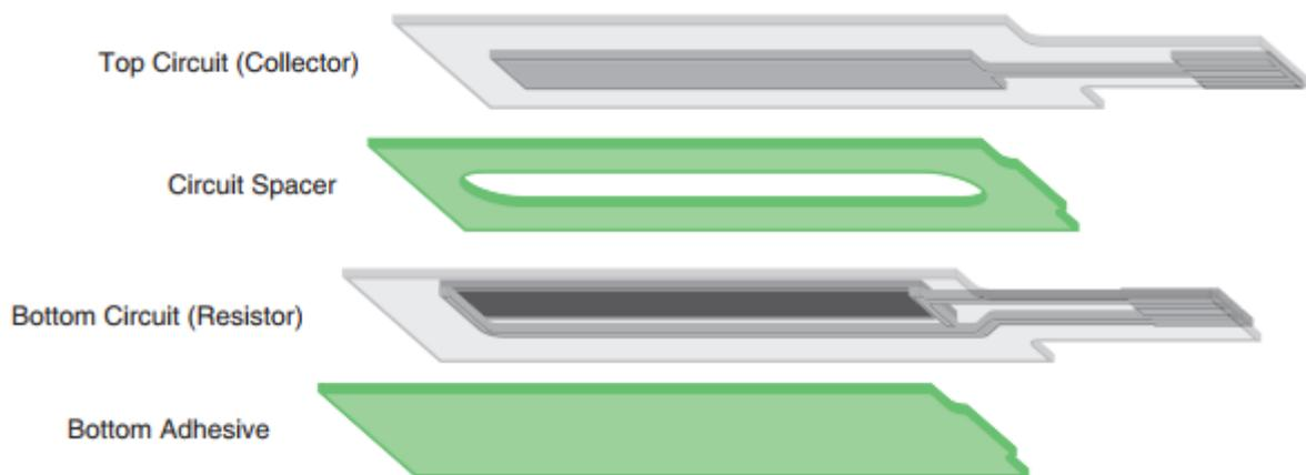
**Figura 4.13 – Struttura Position Sensor**
