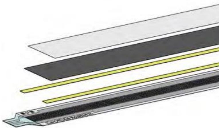
**Figura 4.21 – Struttura FSR Sensor**
