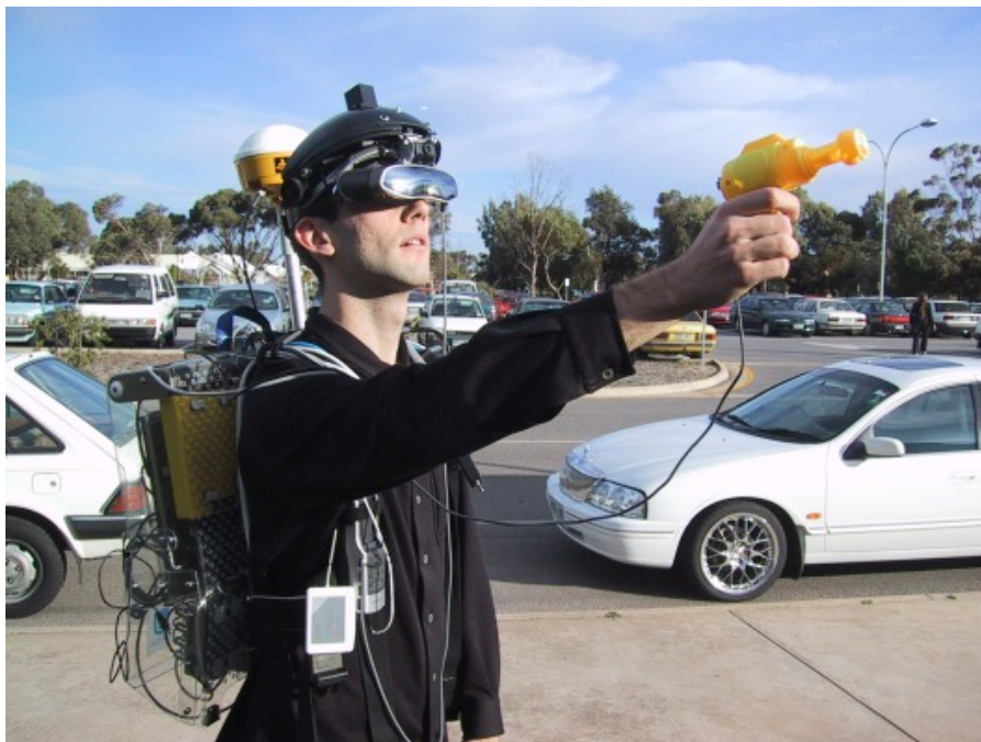
Figura 59: Attrezzatura necessaria per l'esperienza di realtà aumentata di ArQuake.
