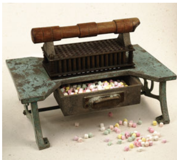
Figura 16: Macchina per produrre a mano le pastiglie Leone. Torino, 1900 ca.
