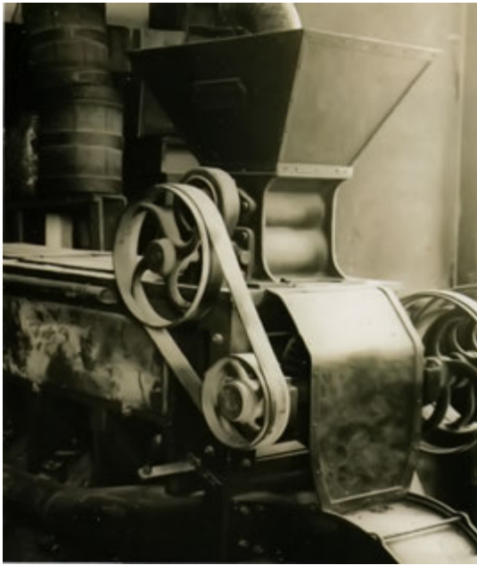
Figura 7: Macchina per smistare i semi di cacao tostati, 1920 ca. Raccolte Museali fratelli Alinari, Firenze.
