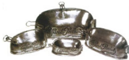
Figura 4: Stampi in acciaio per la fabbricazione a mano del gianduiotto Caffarel. Torino, 1910 ca.[14]
