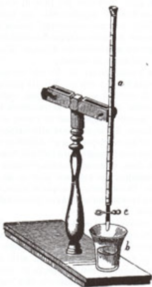
(a) Apparecchio utilizzato per misurare l'acidità nel vino attraverso l'acqua di calce.
