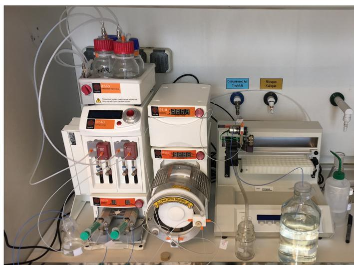
*Figura 2.5: Configurazione base del sistema microfluidico Asia utilizzato in questo progetto.*
