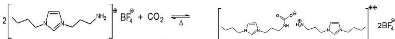
Fig. 2.3.4. Reazione di assorbimento dell'anidride carbonica da parte del [pabim][BF 4 ].
