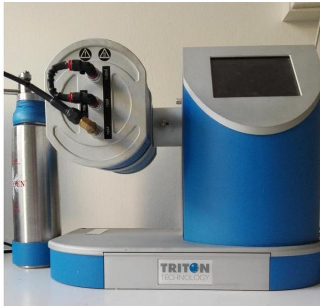
**Figura 3.11:** Strumento utilizzato per l'analisi termico dinamo meccanica
