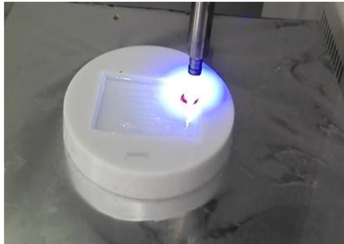
**Figura 4.9:** Avvio della reazione RICFP attraverso sorgente luminosa UV
