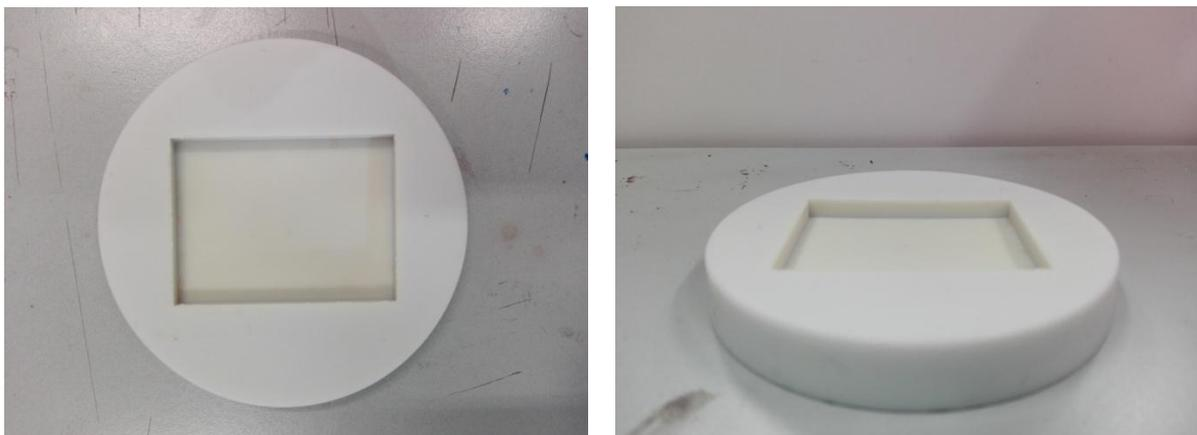
**Figura 3.3:** Stampo utilizzato per la produzione del composito con fibre di vetro
