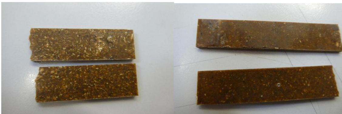
Figura 78: provino con 30% di canapa e c-e Joncryl
