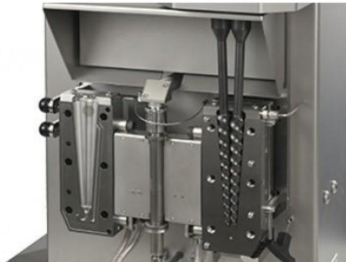
*Figura 42: Dettaglio del miniestrusore con le guance aperte*
