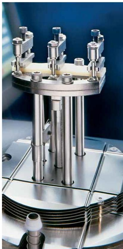
*Figura 47: Particolare della clamp utilizzata per la prova a flessione durante la DMA*
