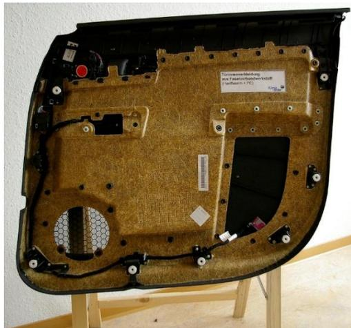
*Figura 7: Interno di una portiera di un'auto composto da polietilene rinforzato con fibre di canapa*
