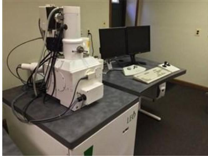
*Figura 44: Microscopio SEM utilizzato per l'attività sperimentale*
