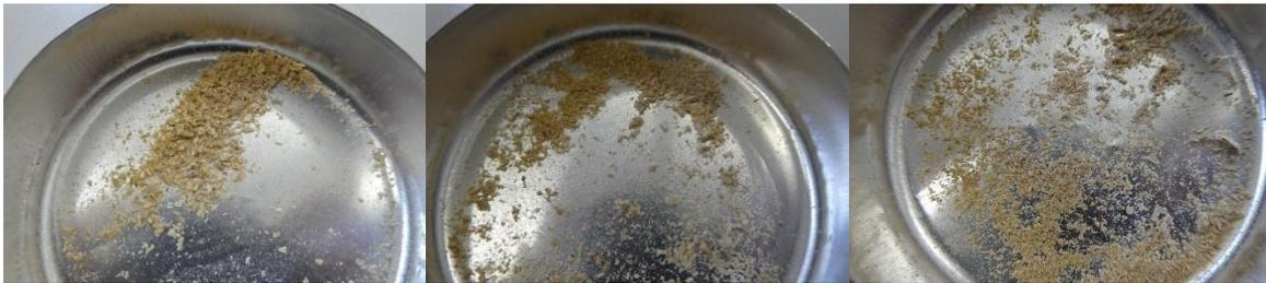
*Figura 80: Polvere di canapa separata da un compound miscelato con una velocità di 15, 100 e 250 rpm*
