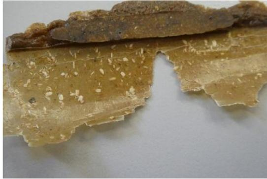
*Figura 40: PLA con 30% canapa e additivo con HLB=8. Si può notare come si sia formata una pellicola facilmente distaccabile che non era presente con altri additivi.*
