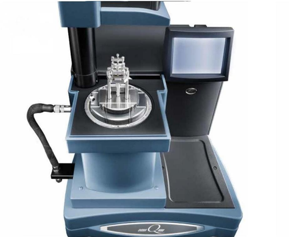
*Figura 46: macchinario per eseguire DMA utilizzato per l'attività sperimentale*
