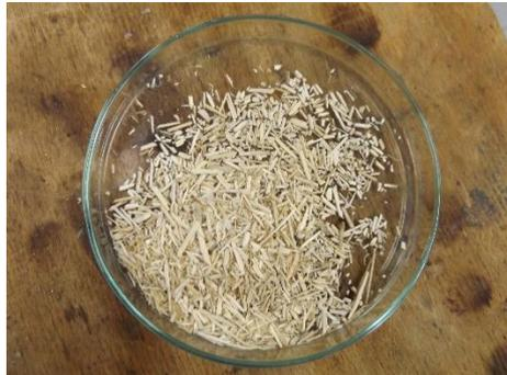
*Figura 30: Fibre di canapa utilizzate nell'attività sperimentale*
