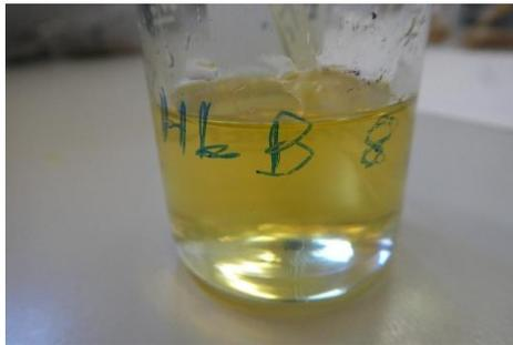
Figura 38: Becher contenente miscela di additivi con HLB=8
