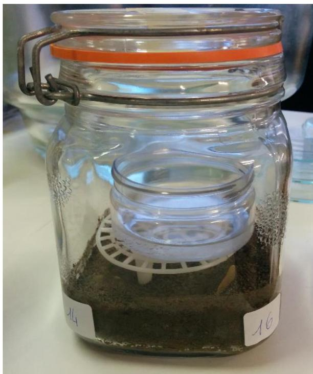
*Figura 3.2 Esempio di microcosmo contenente i campioni di gomma*
