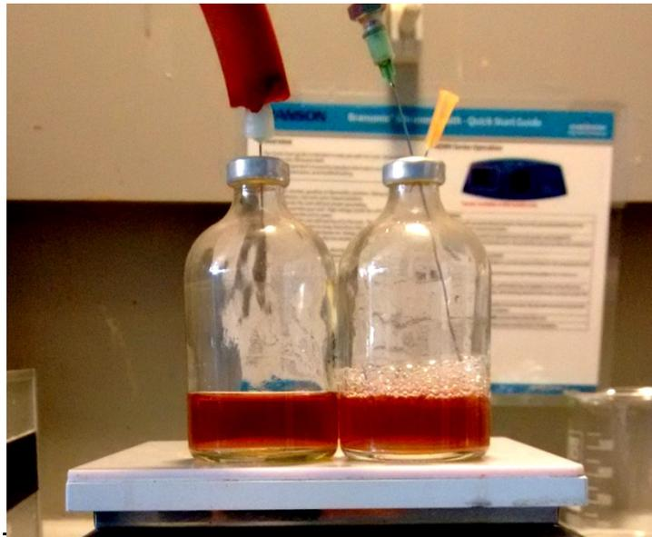
**Figura 2.3** Rimozione dell'aria dal sistema di fermentazione
