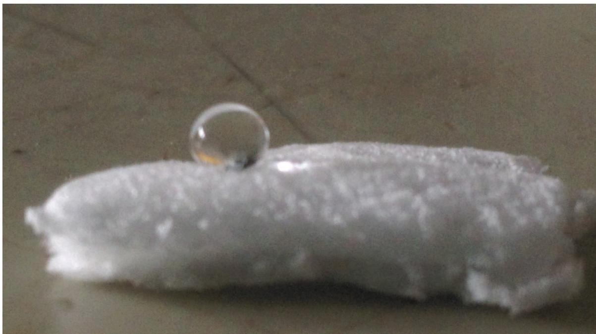
**Figura 3.45:** goccia d'acqua (10  $\mu\text{L}$ ) su aerogel NFC funzionalizzato con nonafluoroetiltrimetossilano.
