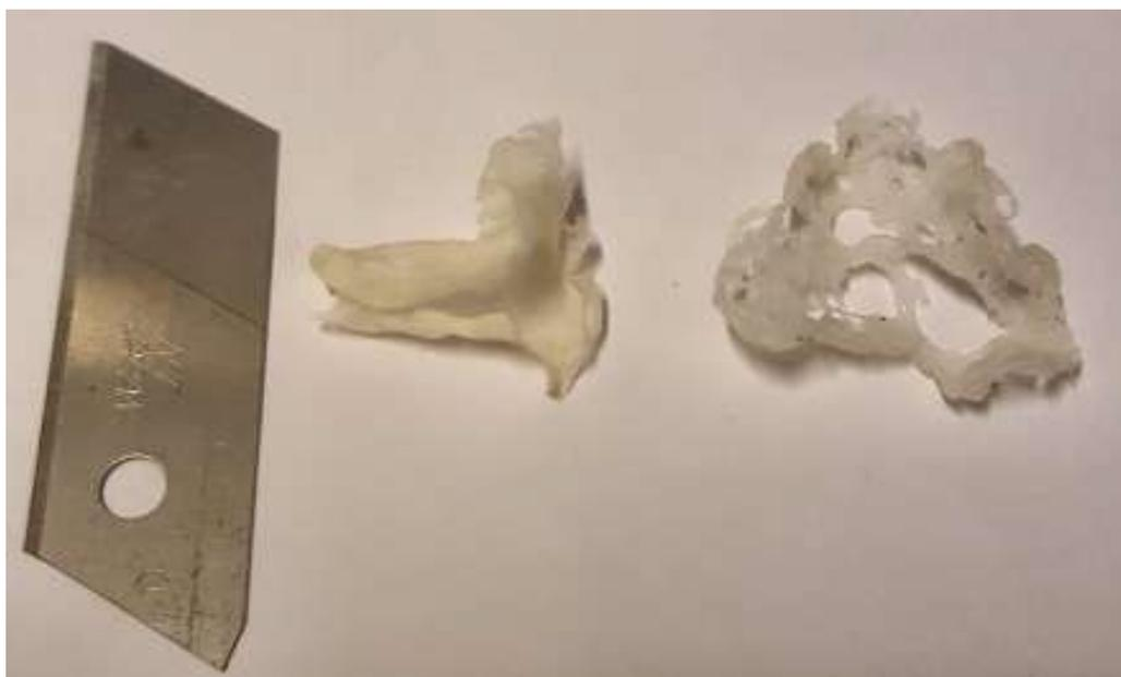
**Figura 3.42:** esempio di restringimento su fogli di NFC. Il campione a destra è al 50% in peso di NFC gel e HBP\_5Si. Il campione a sinistra è al 25% in peso di gel di NFC con resina HBP.
