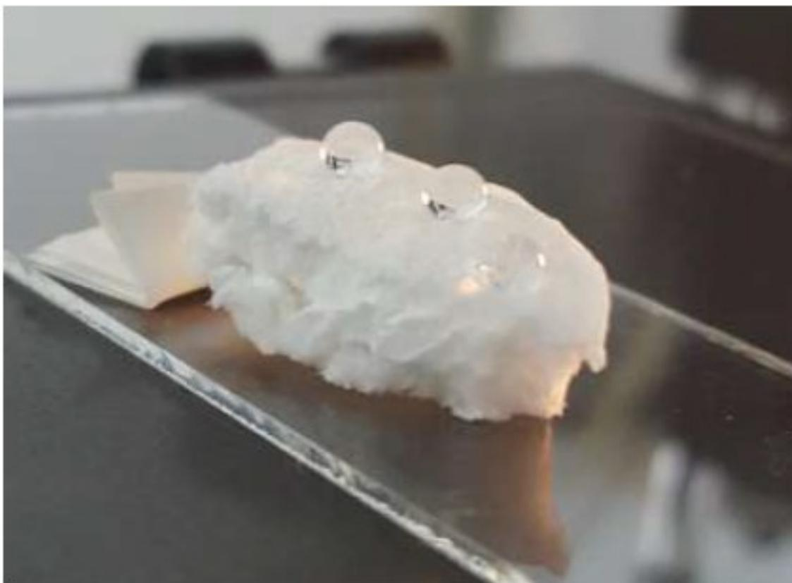
**Figura 3.43:** gocce d'acqua (10  $\mu$ L) su aerogel NFC ricoperto con spray della resina HBP\_5F.
