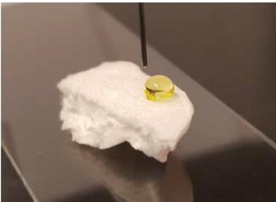
**Figura 3.44:** goccia d'olio (10  $\mu$ L) su aerogel NFC ricoperto con spray della resina HBP\_5F.
