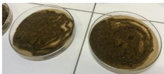
**Figura 6.** Inquinamento del suolo con gasolio su piastra.
