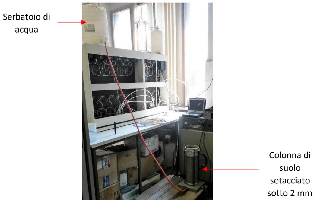
**Figura 3.** Prova di infiltrazione
