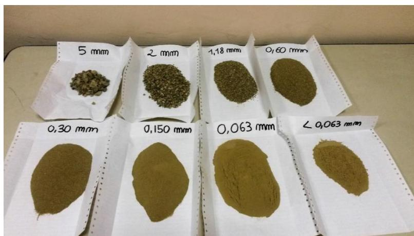
**Figura 8.** Frazioni ottenute mediante setacciatura
