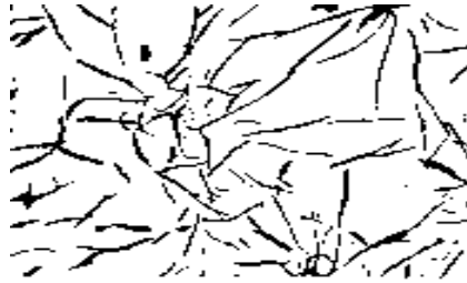
Figura 8 : Ghise grigie senza aggiunto di Mg e Ce
