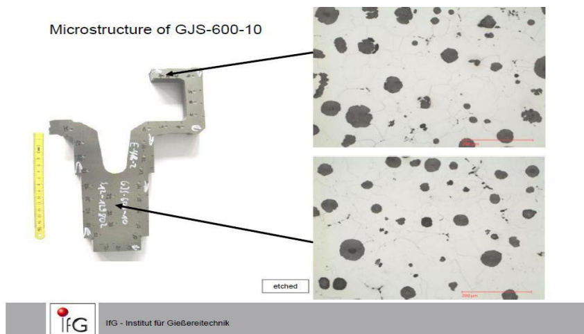
Figura 34 : Microstruttura GJS-600-10 Spessore differente 10
