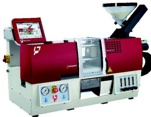
**Figura 4.3:** pressa da laboratorio per stampaggio ad iniezione
