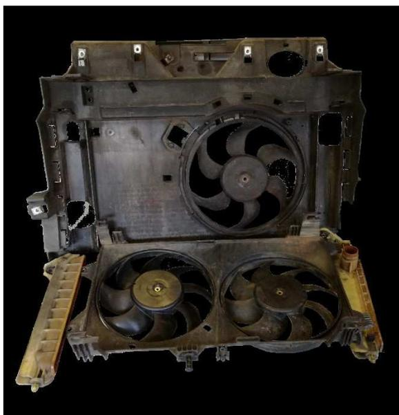
**Figura 4.1:** sistema di raffreddamento in materiale composito (PA6,6 + 30%GF)
