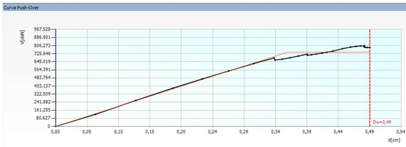
Figura 51. Curva di capacità del caso peggiore, analisi 24, direzione -Y eccentricità 515,5 cm
