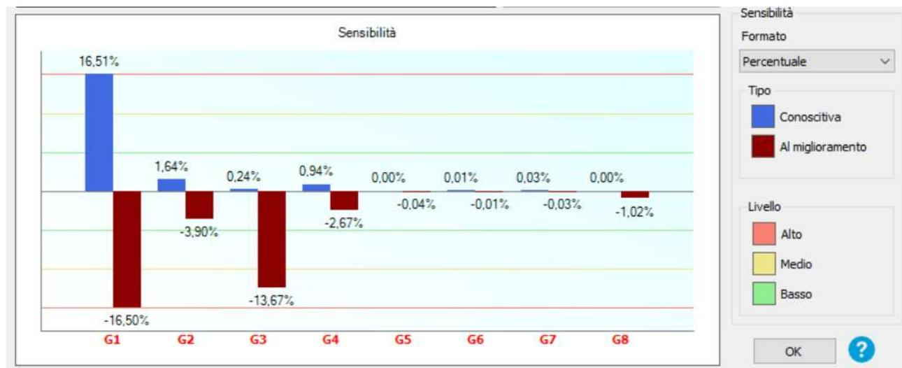
Figura 55. Grafico dell'analisi di sensibilità ricavato con il software 3MURI
