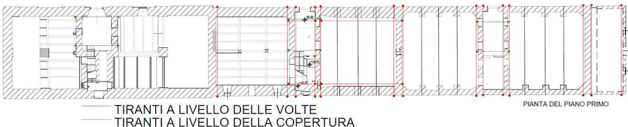
Figura 63. Posizione dei tiranti applicati al modello WinStrand costruito con l'analisi di sensibilità
