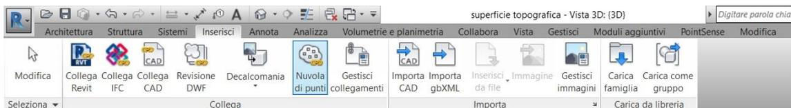
Figura 94: Inserimento della Nuvola di punti attraverso il comando "Inserisci" nella barra degli strumenti.
