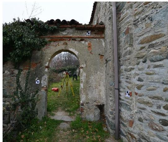
Figura 31: Posizionamento dei *target* a terra e sulle pareti dell'edificio rilevato.
