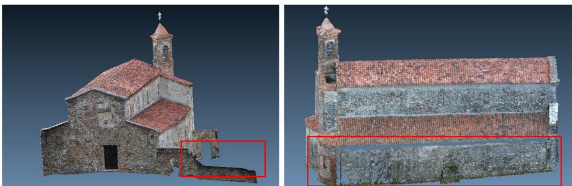
Figura 71: Criticità del modello fotogrammetrico riscontrate per la parte inferiore dei prospetti.
