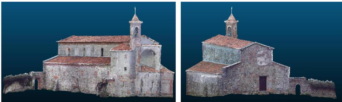
Figura 87: visualizzazione del modello finale ottenuto dalla sovrapposizione delle due nuvole di punti.
