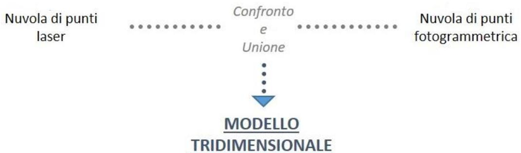
Figura 72: creazione del modello tridimensionale finale dal confronto e dall'unione delle due nuvole di punti.
