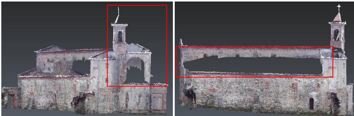
Figura 70: Criticità del modello *laser scanner* riscontrate per le parti non rilevabili dell'abside, del campanile e del prospetto sud.
