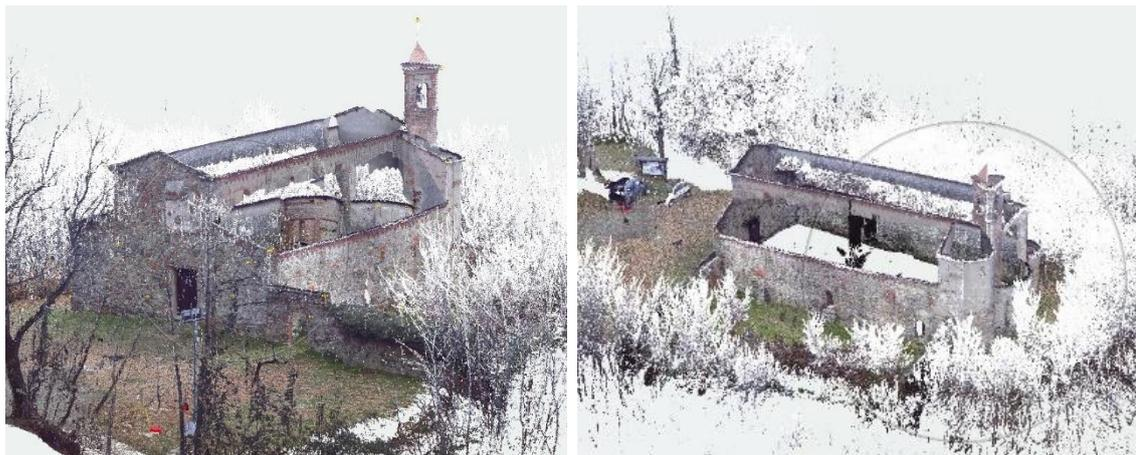
Figura 54: Risultato finale dell'elaborazione della nuvola ottenuta con *laser scanner*.
