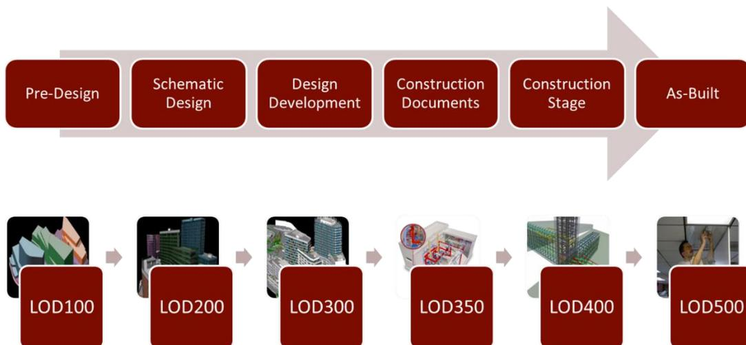
Figura 4.3.1 - LoD come livelli di sviluppo del progetto
