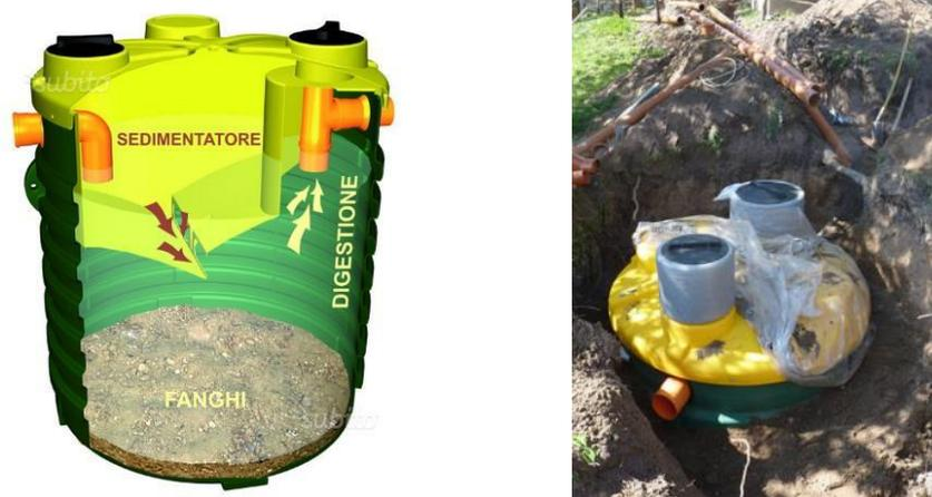
Figura 6.4.1 - Schema d funzionamento della vasca Imhoff e la sua posa in opera
