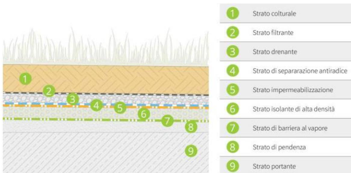
Figura 9: sistema Il.A.Dn.Is. (intensivo leggero, piano, drenaggio naturale, isolato termicamente).
