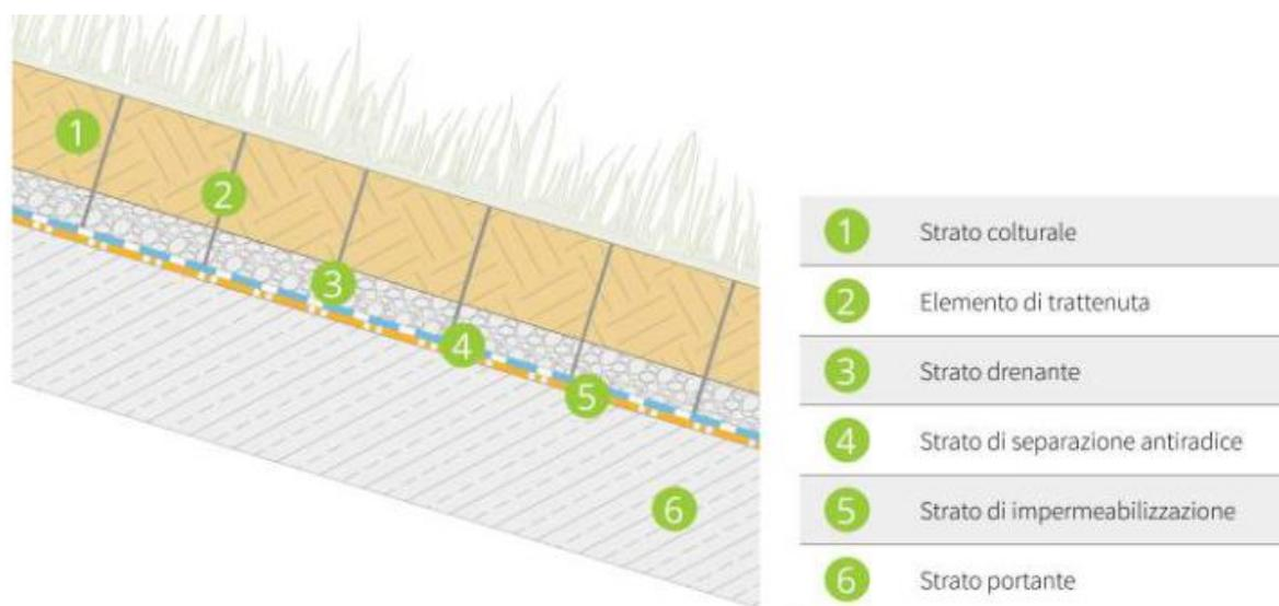
Figura 14: sistema II.B.Dn.Ns. (intensivo leggero, inclinato, drenaggio naturale, non isolato).
