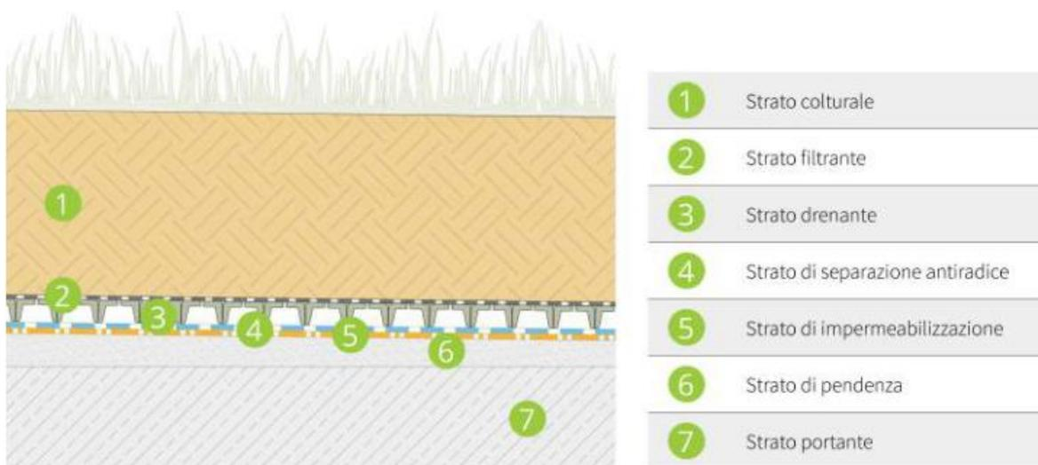
Figura 18: sistema Ip.A.Da.Ns. (intensivo pesante, piano, drenaggio artificiale, non isolato).
