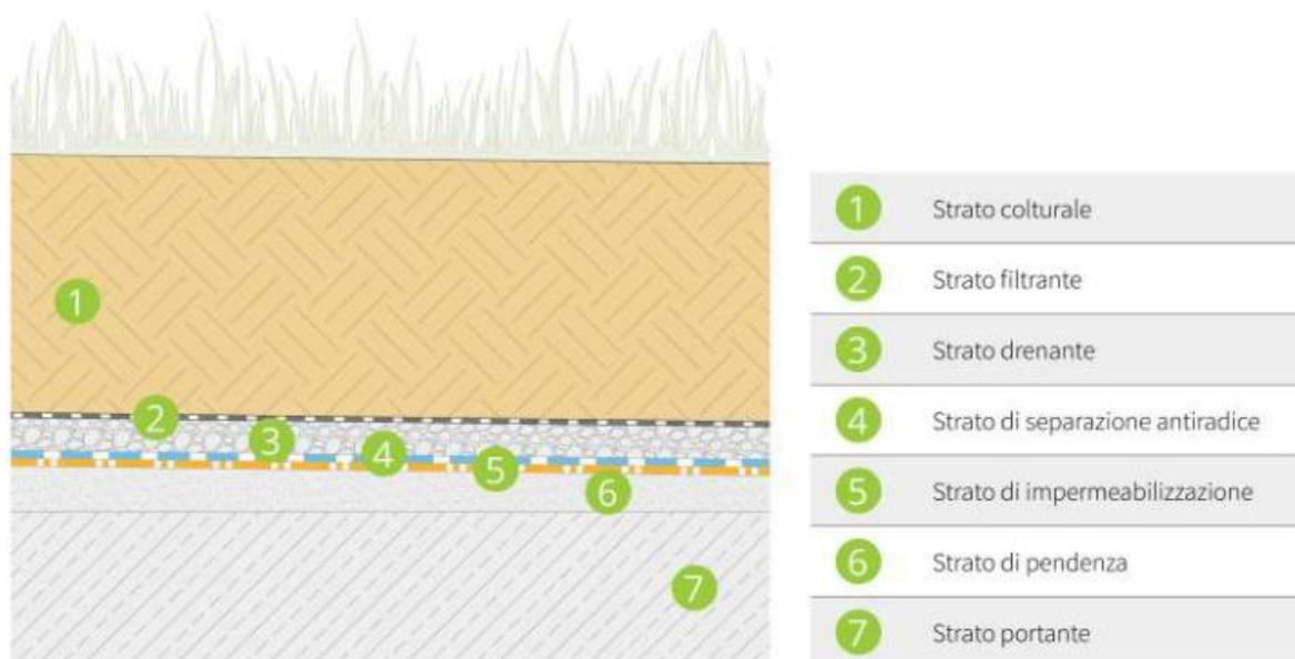
Figura 17: sistema Ip.A.Dn.Ns. (intensivo pesante, piano, drenaggio naturale, non isolato).
