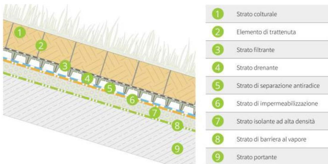
Figura 15 :sistema Il.B.Da.Is. (intensivo leggero, inclinato, drenaggio artificiale, isolato termicamente).
