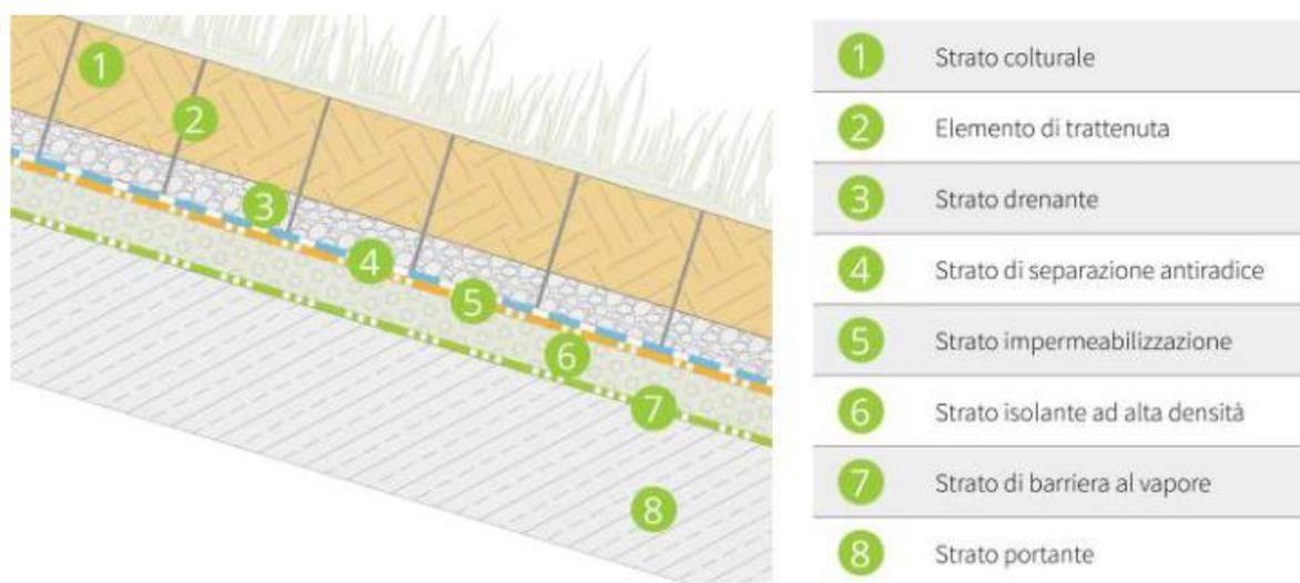
Figura 13: sistema Il.B.Dn.Is. (intensivo leggero, inclinato, drenaggio naturale, isolato termicamente).
