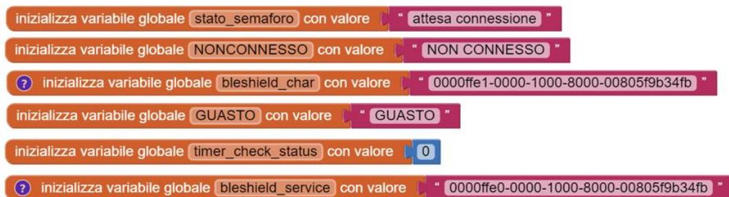
Figura 108 - MIT App Inventor blocchi variabili globali BLE Test
