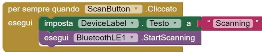
Figura 109 - MIT App Inventor blocco ScanButton
