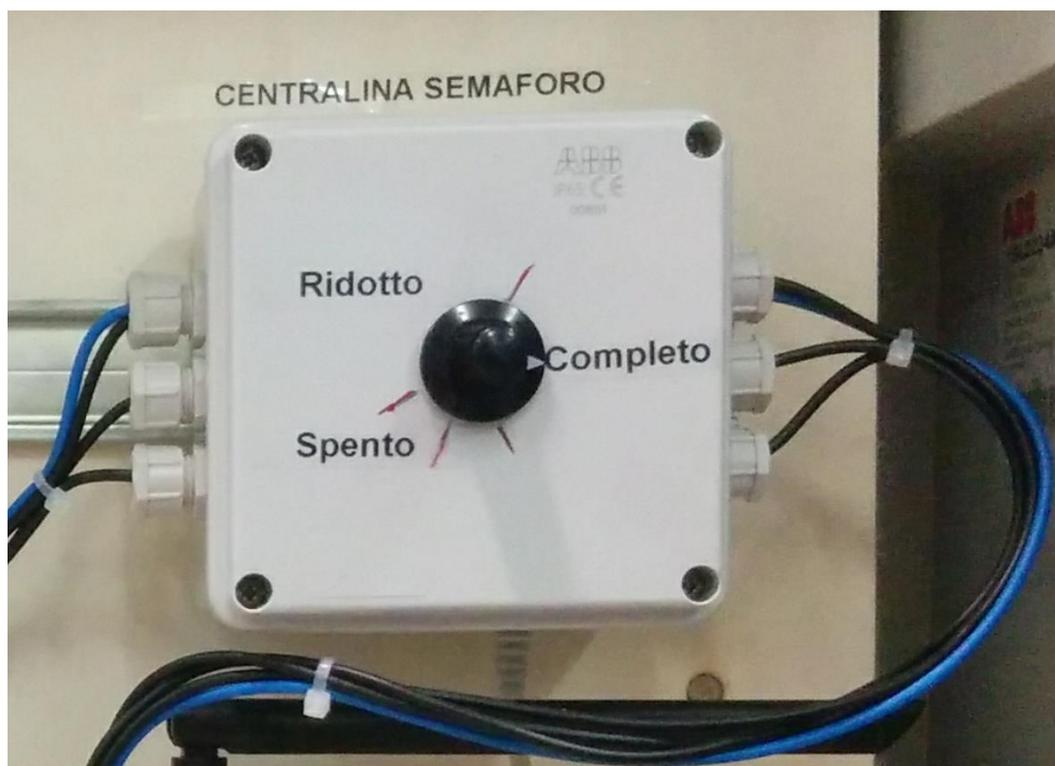
*Figura 49 - Centralina semaforica completa*
