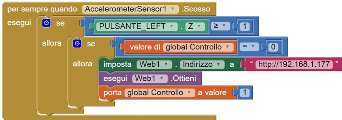
Figura 86 - MIT App Inventor blocco Accelerometro
