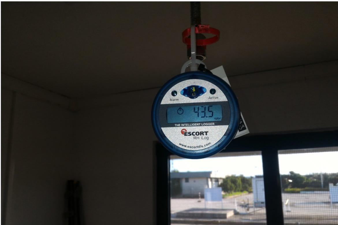
**Figura 5.12:** Termoigrometro ESCORT utilizzato nelle prove.
