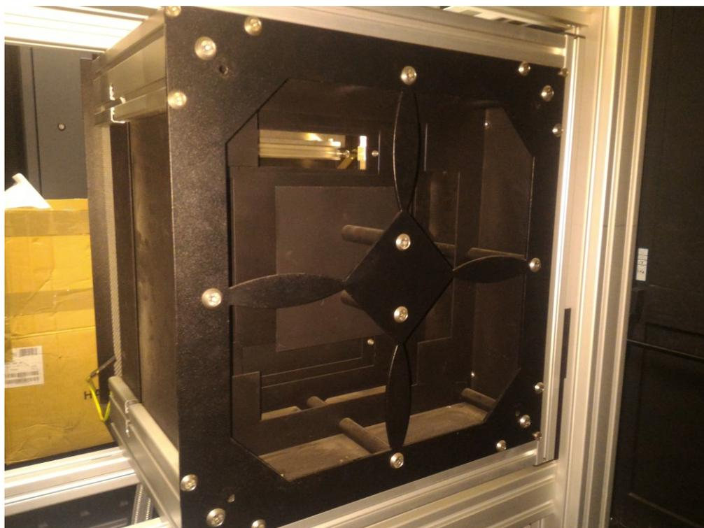
**Figura 5.4:** Emittitore flash del Solar Simulator con due lampade allo Xeno
