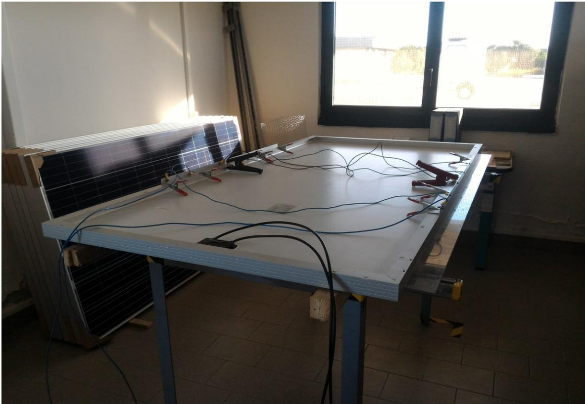
**Figura 5.9:** Setup di configurazione, modulo su tavolo metallico con backsheet rivolto verso l'alto.
