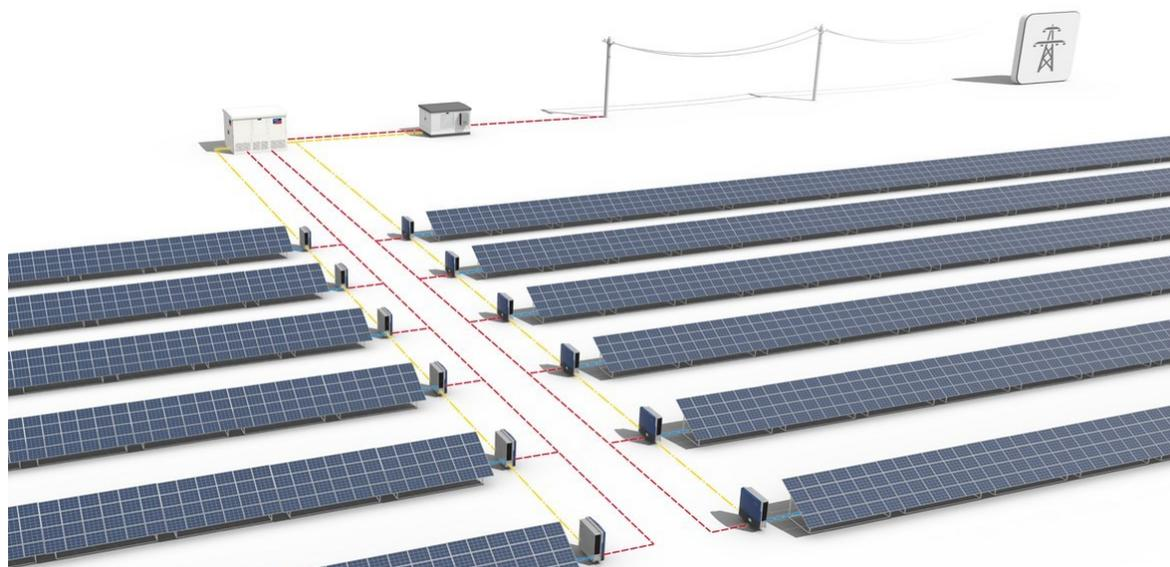
**Figura 1.19:** Schema di principio di un impianto fotovoltaico con string-inverter SMA.
