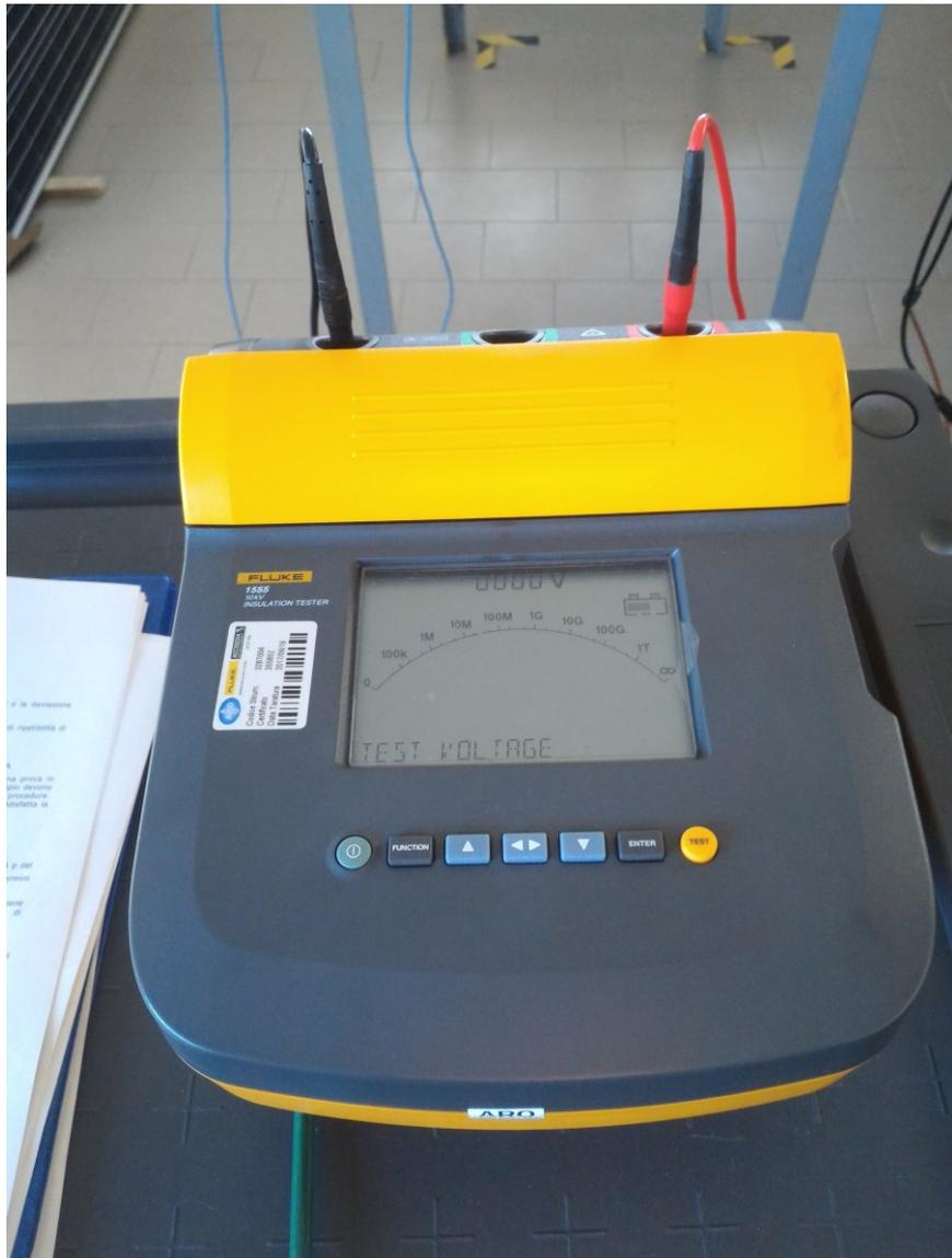
**Figura 5.13:** Megaohmetro Fluke 1555 utilizzato nella prova.
