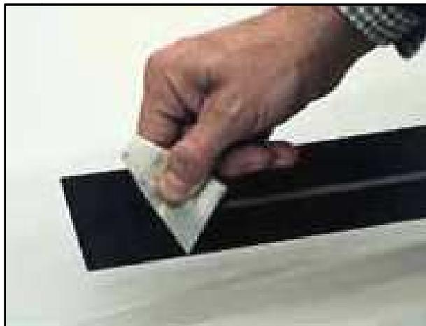
*Figura 1.3.2 : Lamina pultrusa in fibra di carbonio*
