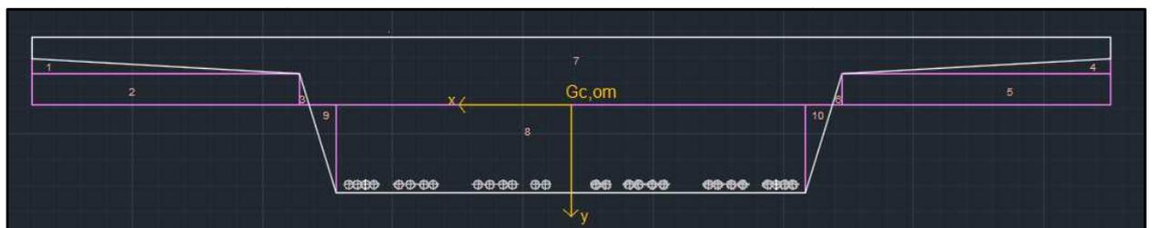
**Figura 5.1.6 : Scomposizione della sezione in geometrie elementari**
