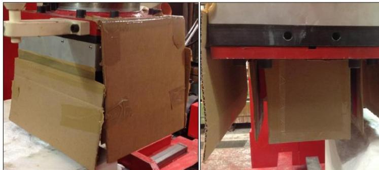
**Figura 5.7 Telaio di cartone per il confinamento del detrito (Rispoli, 2013).**
