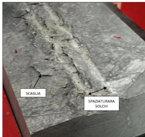
**Figura 3.9 Influenza delle discontinuità sul meccanismo di rottura. Provino di roccia scistosa (Rispoli, 2013).**
