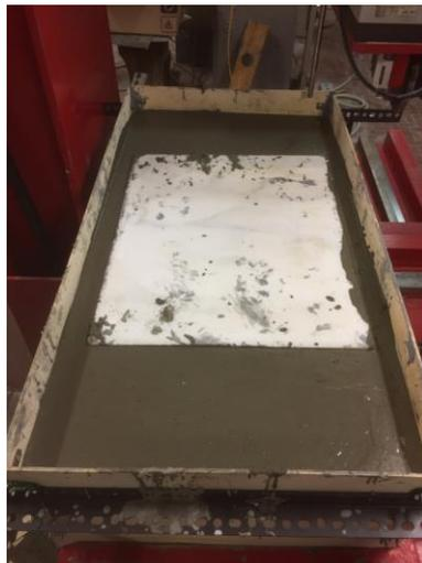
**Figura 5.15** Miscela di cemento colata all'interno della cassaforma (Montes, 2016)
