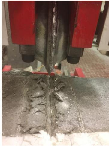
Figura 5.10 Realizzazione del solco sul provino ad opera del disco (Montes, 2016).
