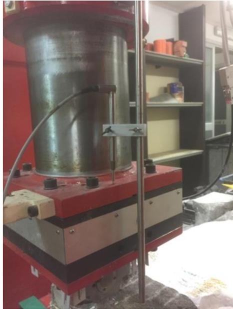
Figura 5.19 Trasduttore LVDT (Montes, 2016).
