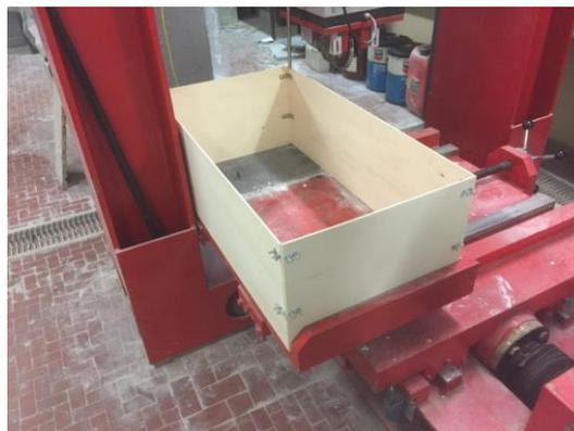
Figura 5.13 Cassaforma montata sulla sample box prima della miscelazione del cemento (Montes, 2016).
