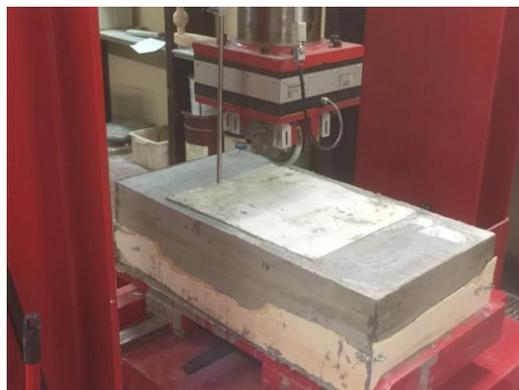
**Figura 5.16** Campione pronto per essere testato (Montes, 2016).
