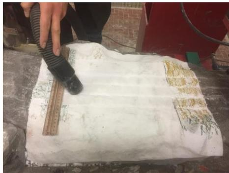
Figura 5.22 Rimozione del detrito con aspiratore (Montes, 2013).
