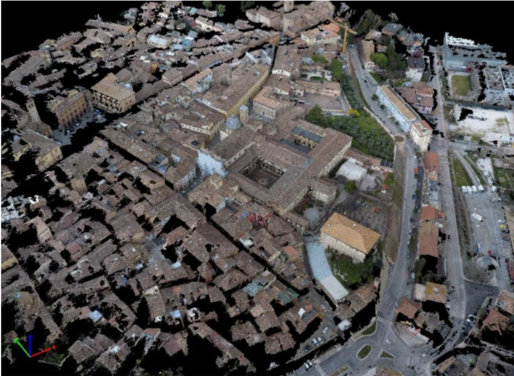
*Fig. Nuvola di punti ricavata grazie al processo fotogrammetrico dai dati acquisiti (Rif. Gruppo di Geomatica del Politecnico di Torino)*
