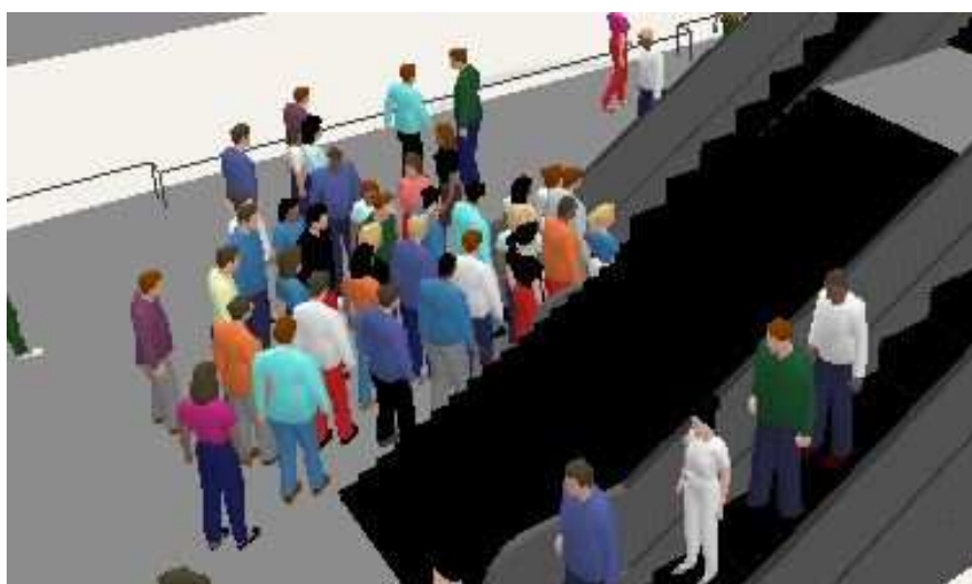
Figura 4. 20: congestione ai piedi di una scala mobile dovuta ad un comportamento pedonale da rivedere in Viswalk.
