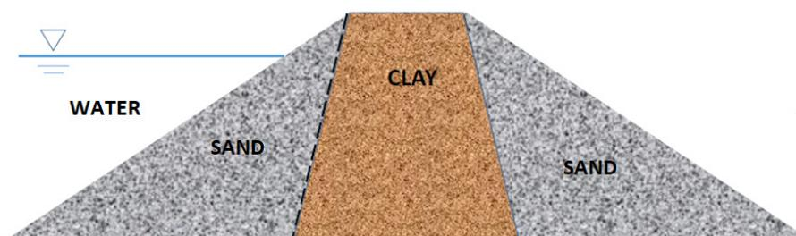
Figura 2.1 Diga in materiale sciolto con nucleo centrale in argilla
