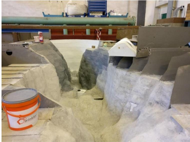
*Figura 11: rivestimento con membrana impermeabile*
